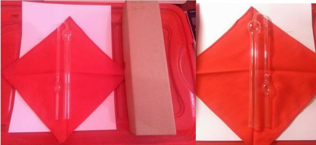
Para medir la gravedad específica o (densidad relativa de líquidos), la proporción de la densidad del líquido a la densidad del agua. Usaremos un densímetro.
