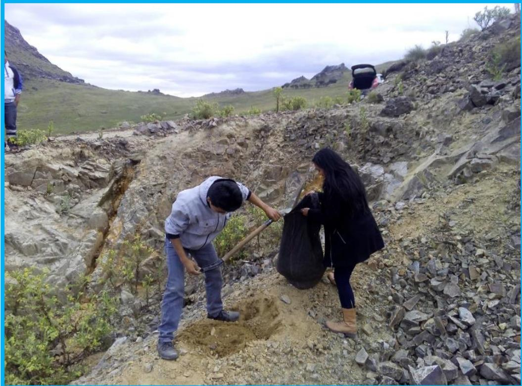
Foto N° 7: Extracción del material de cantera, para ser analizados en el laboratorio de Mecánica de Suelos de la Universidad Cesar Vallejo – Trujillo.
