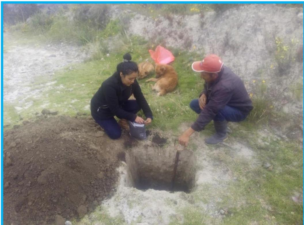
Foto N° 8: Se realizó la extracción de material para realizar los estudios respectivos, para conocer las características del suelo.
