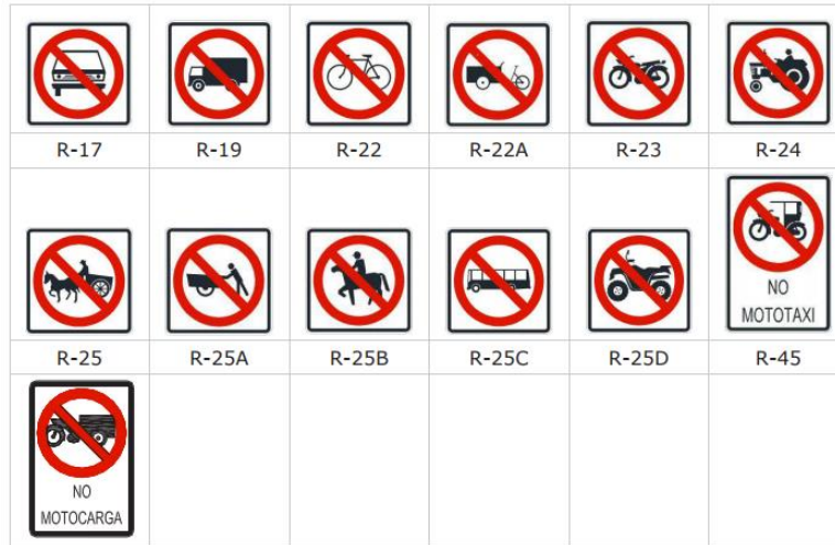
FIGURA Nº 13: Señales de Paso por Clase de Vehículo
