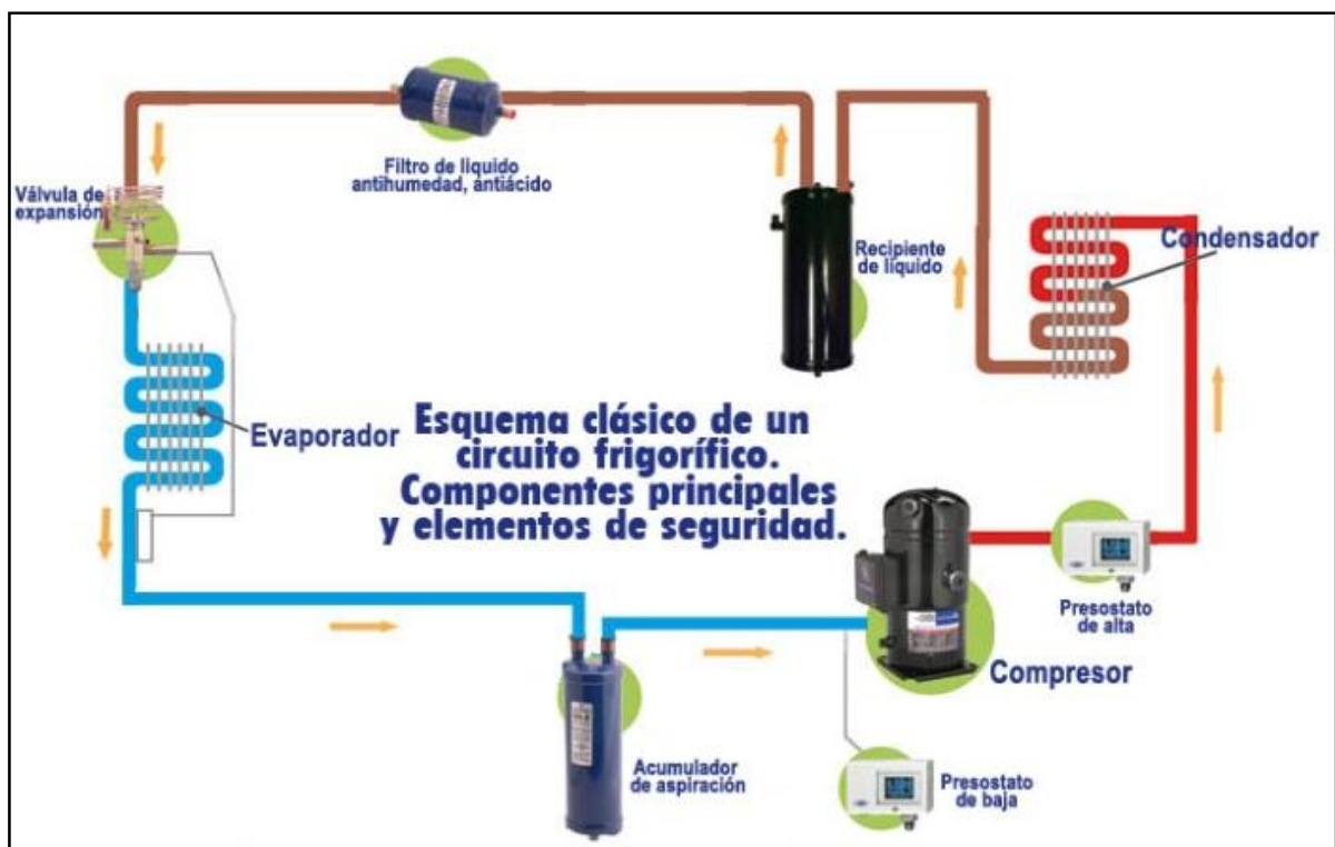
Figura 8. Funcionamiento del sistema frigorífico
