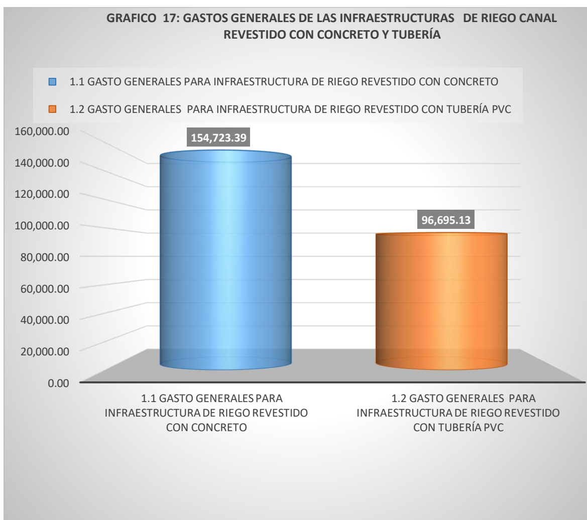
Gráfico 17: Gastos Generales de las infraestructuras de riego, canal revestido con concreto vs canal revestido con tubería PVC
