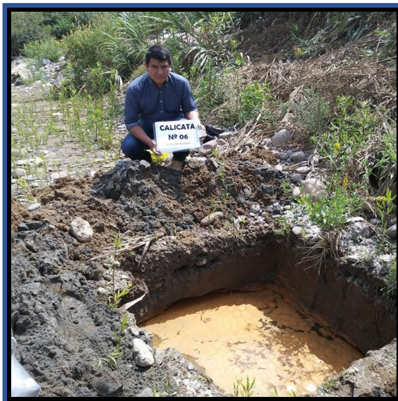
FOTOGRAFÍA 21: Excavación de la calicata # 06 en la cuenca del río Moche en la jurisdicción del distrito de Moche
