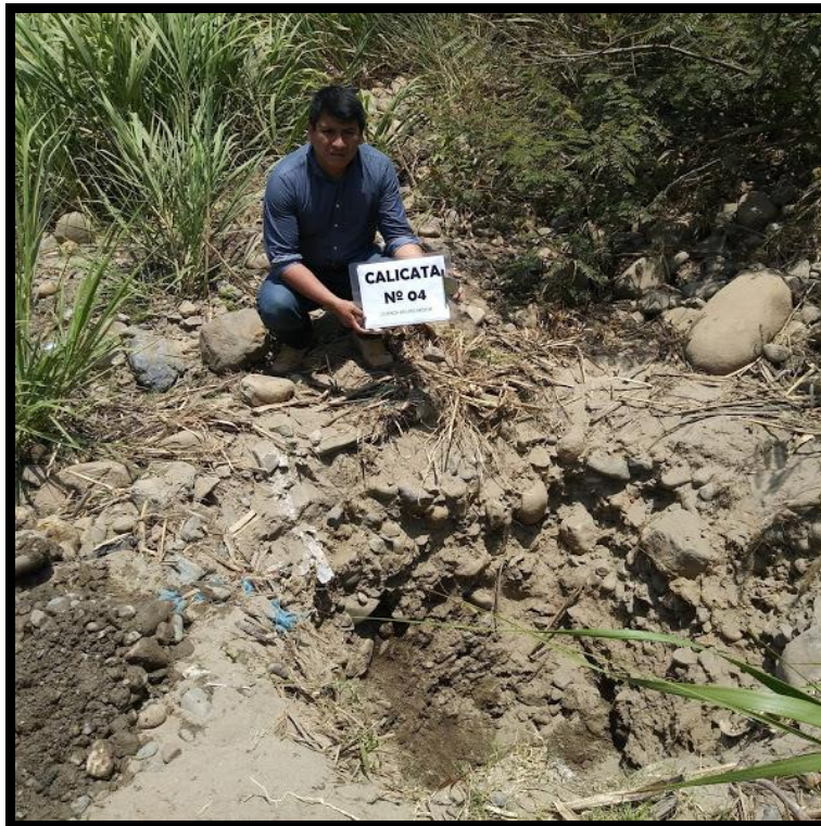
FOTOGRAFÍA 19: Excavación de la calicata # 04 en la cuenca del río Moche en la jurisdicción del distrito de Moche
