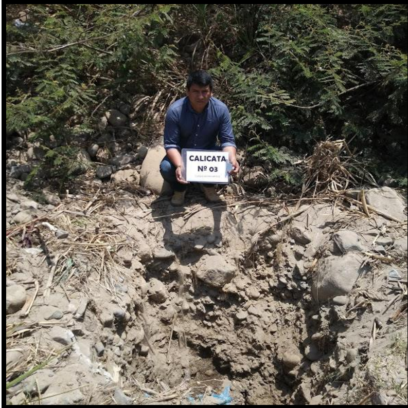
FOTOGRAFÍA 18: Excavación de la calicata # 03 en la cuenca del río Moche en la jurisdicción del distrito de Moche
