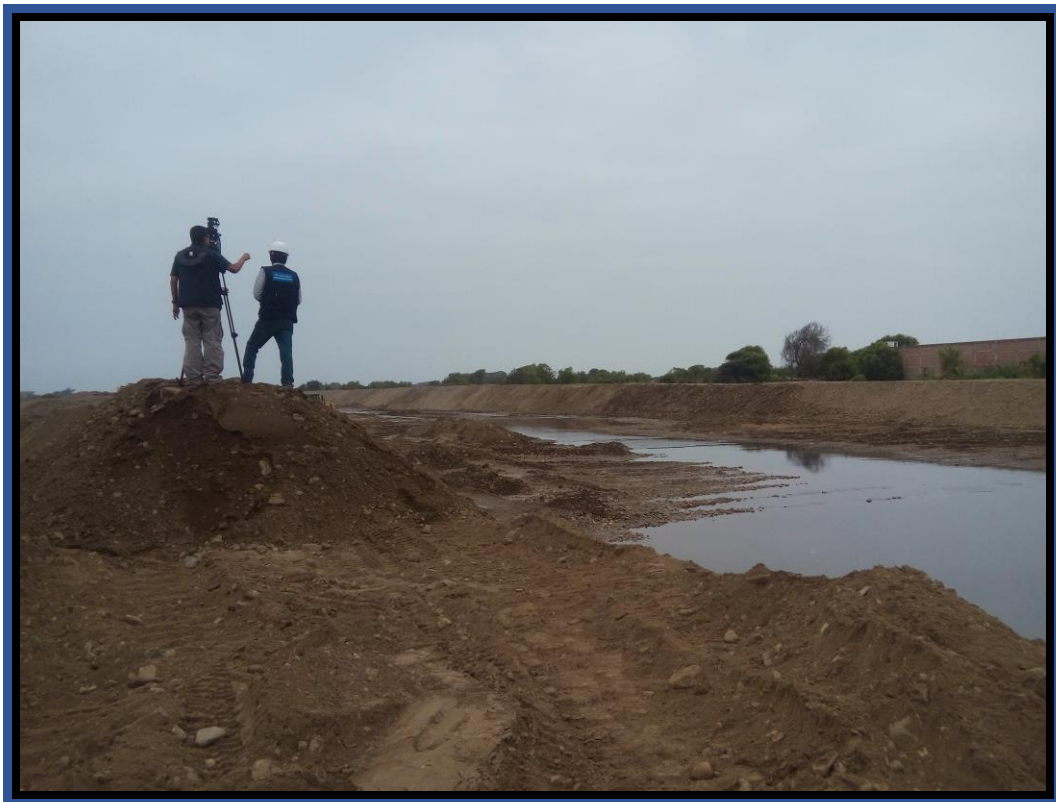
FOTOGRAFÍA 13: Toma de datos con estación total TOPCON en La cuenca del río Moche en la jurisdicción del distrito de Moche
