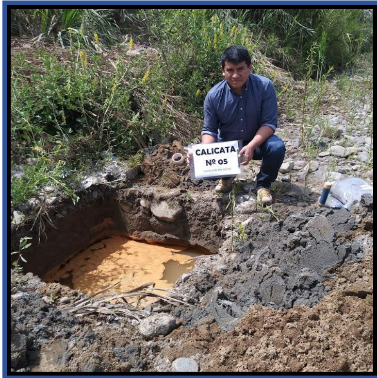
FOTOGRAFÍA 20: Excavación de la calicata # 05 en la cuenca del río Moche en la jurisdicción del distrito de Moche
