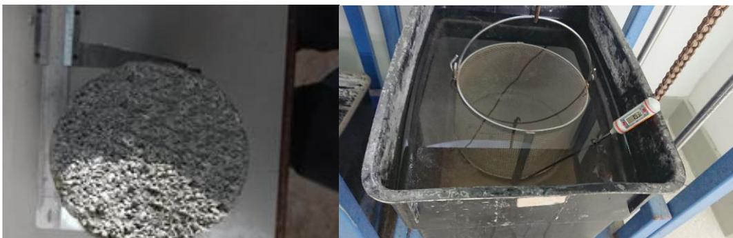
Figura 25. Medición usando el pie de rey (vernier) y medición de temperatura del agua con el termómetro. Fuente: Elaboración propia.
