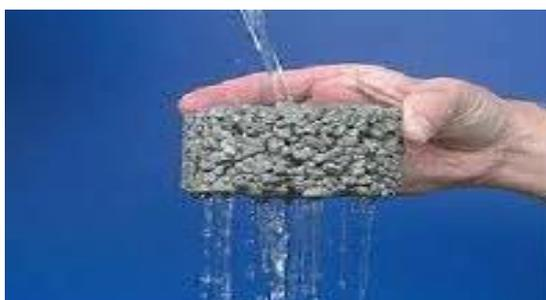
*Figura 5.* Propiedad de permeabilidad del concreto permeable. Fuente: Lucke et al (2013)
