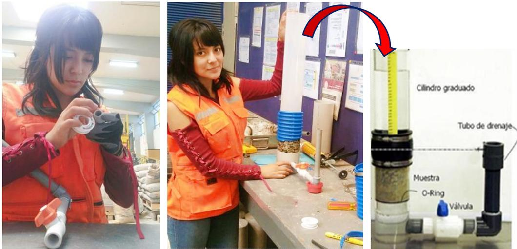
Figura 29. Elaboración del permeámetro de carga variable (ACI 522). Fuente: Elaboración propia.
