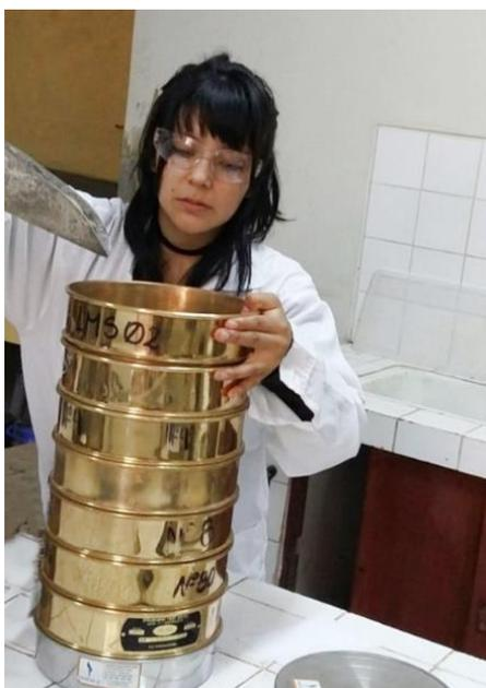
*Figura 12.* Empleo de mallas para tamizado. Fuente elaboración propia
