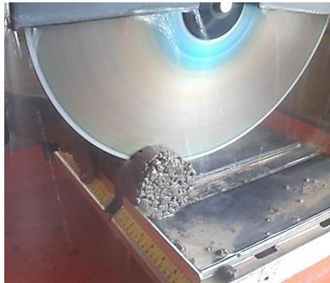
Figura 23. Proceso de corte de briqueta. Fuente: Elaboración propia
