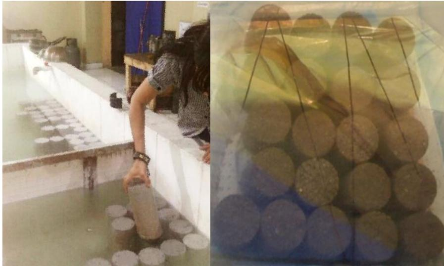
Figura 20. Proceso de inmersión para curado de las probetas de concreto. Fuente: Elaboración propia.
