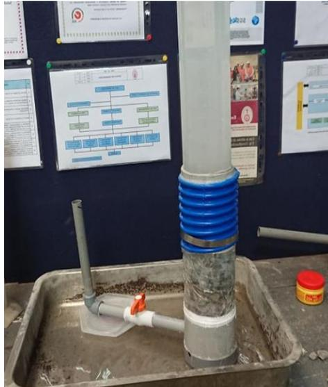
Figura 24. Permeámetro listo para ser usado. Fuente: Elaboración propia
