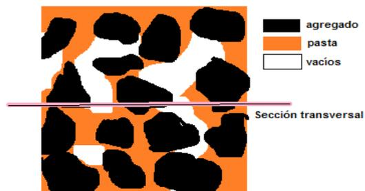
Figura 4. Componentes y contenido de vacíos de mezcla. Fuente: Elaboración propia.
