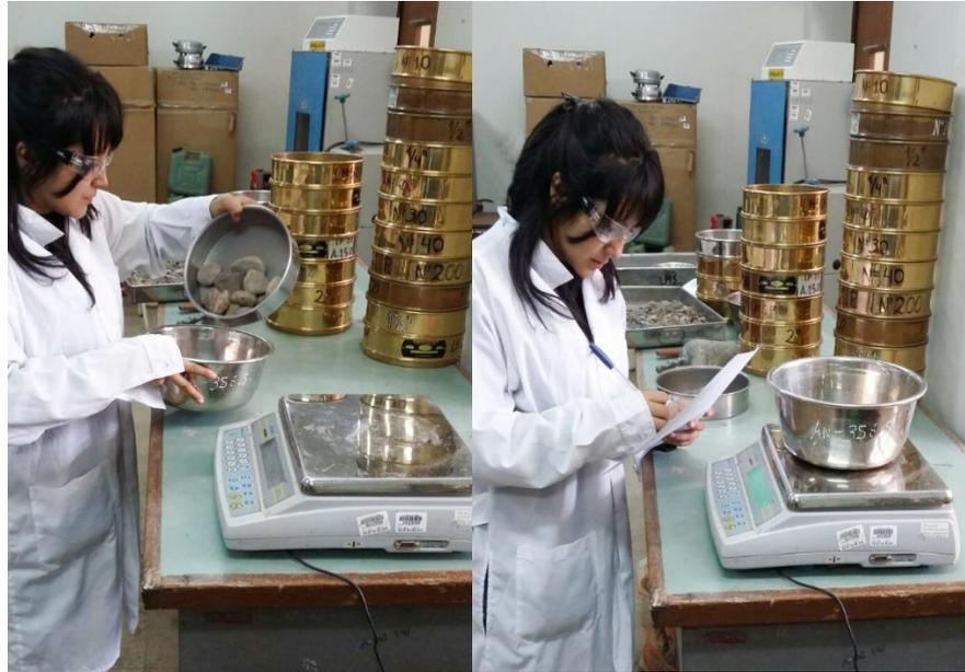
Figura 13. Pesado de material por malla. Fuente: Elaboración propia
