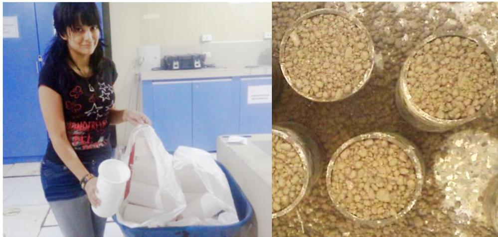
Figura 19. Moldes plásticos utilizados y probetas de concreto permeable compactado. Fuente: Elaboración propia.
