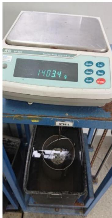
Figura 27. Saturación del testigo de concreto permeable. Fuente: Elaboración propia
