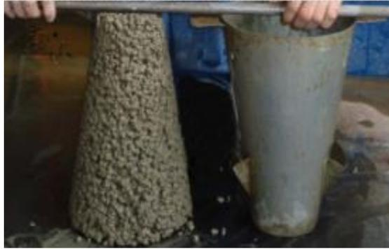
Figura 17. Obtención de trabajabilidad mediante el cono de Abrams. Fuente: Elaboración propia
