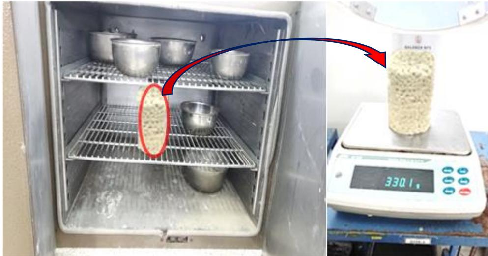
Figura 26. Secado y pesado del testigo. Fuente: Elaboración propia.
