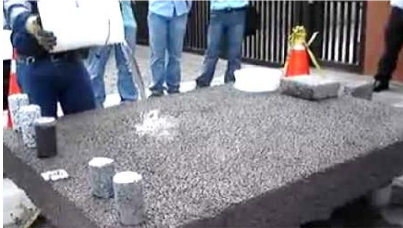
*Figura 1.* Concreto permeable en estado seco. Fuente: Youtube
