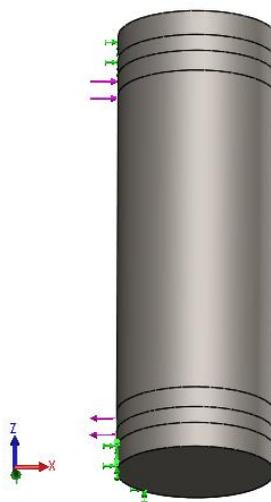
Figura 3.40. Modelo de estudio del pasador (cargas y sujeciones).
