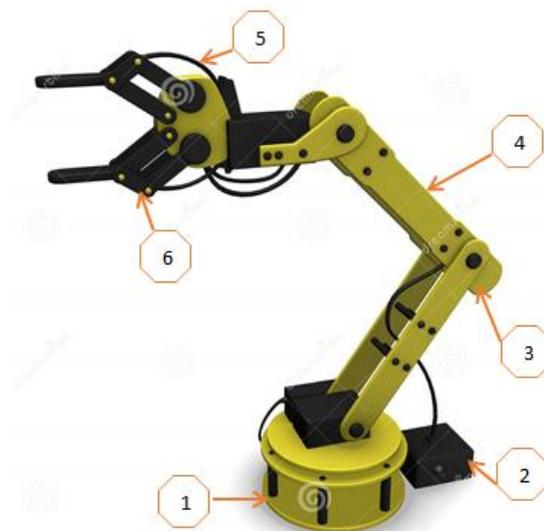
Figura 1.4 Brazo esférico (fuente Lynxmotion).
