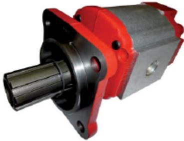
Bomba de engranajes con sentido de giro reversible y drenaje interno. Construida con cuerpo de aluminio, más ligera y que permite trabajar a altas presiones con un bajo nivel de ruido.
