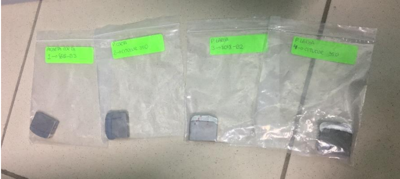
Figura 17 Probetas seleccionadas para hacer ensayos de Dureza y Microestructura
