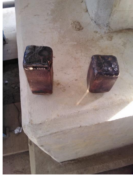
Figuras 15 Probetas rellenas con soldadura Citodur 350, E 8018 B2, E 9018 B3 con su respectivo Buttering cada una de ellas
