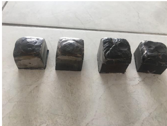
Figura 16 Probetas separadas para identificar la característica del electrodo utilizado
