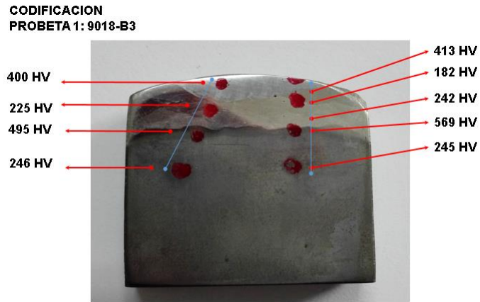
Figura 20 Probeta soldada con electrodo E 9018-B3
