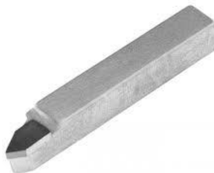
Figura 3.6 Cuchilla de corte de tungsteno aleado
