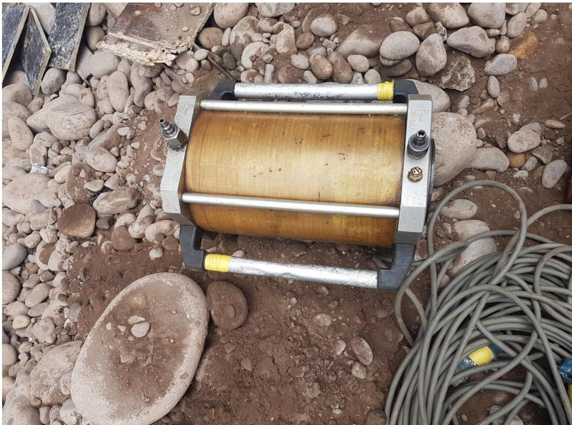
Figura 10. Gata hidráulica para tensado de cables
