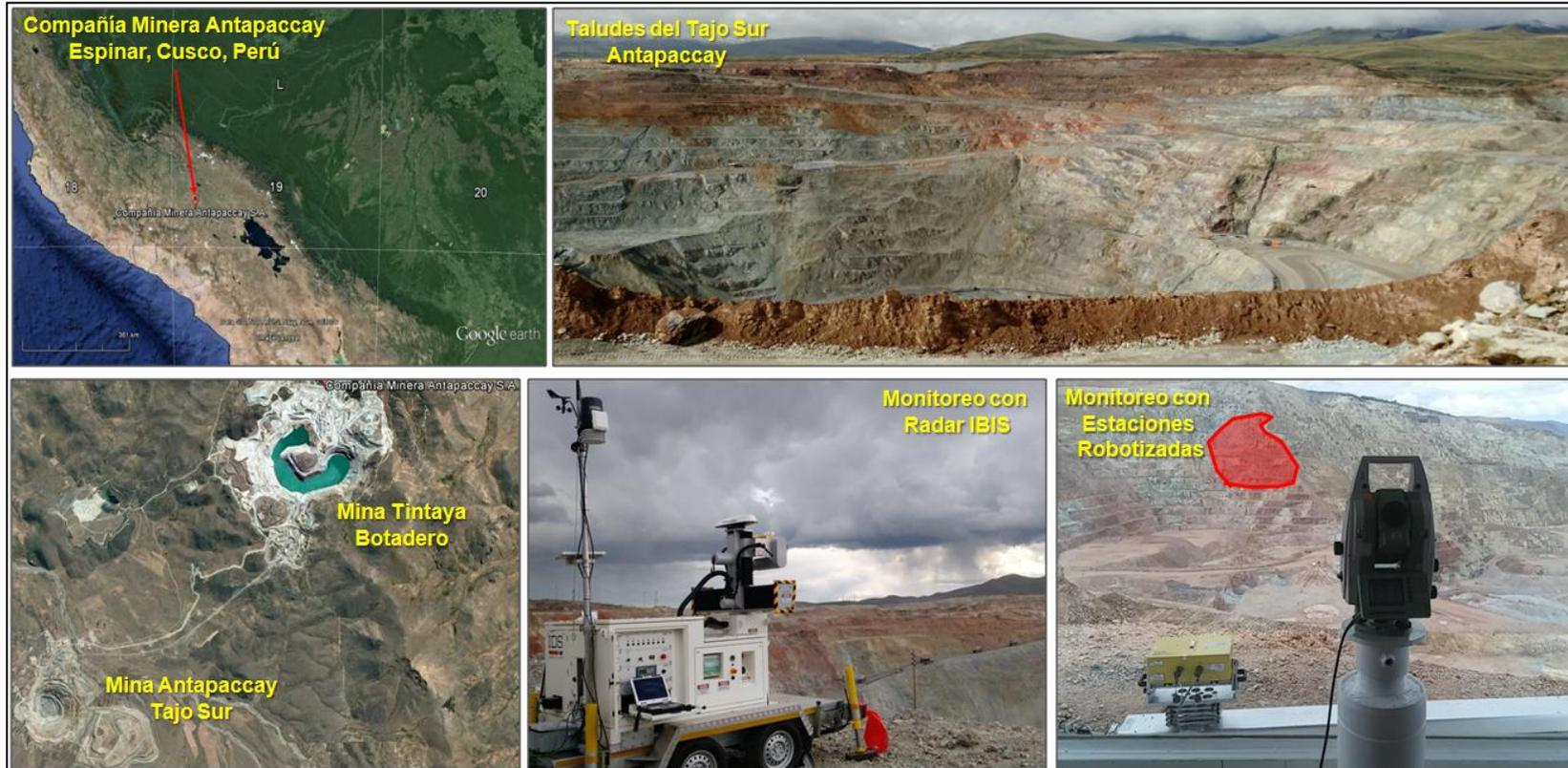
Figura 8.2: Registro de equipos de monitoreo en mina.
