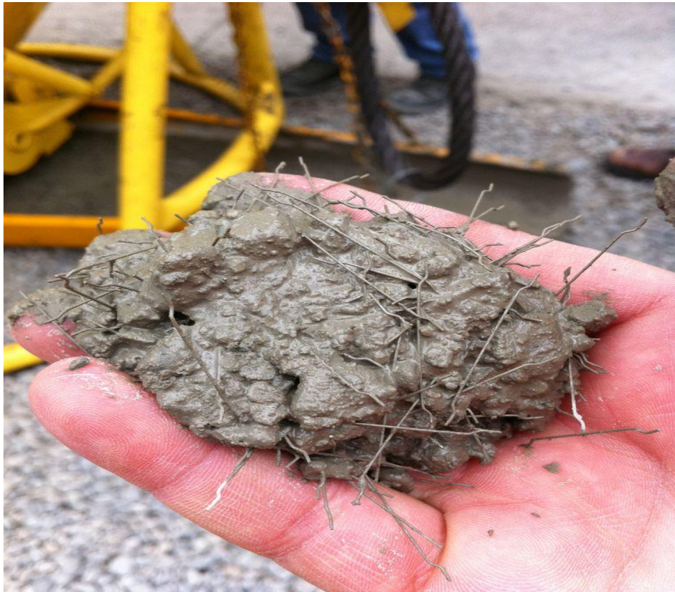
Figura 03. Concreto con fibras de acero. Fuente: propia
