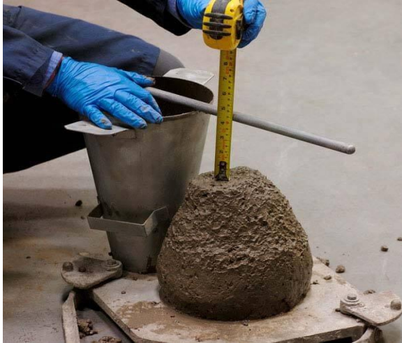
Figura 08. Asentamiento sin fibra de Acero.
