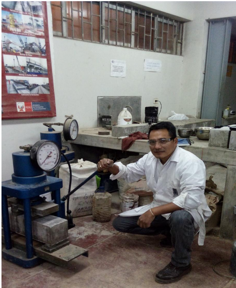
Figura 35. Ensayo de resistencia a la flexión de la viga. Fuente: Propia.
