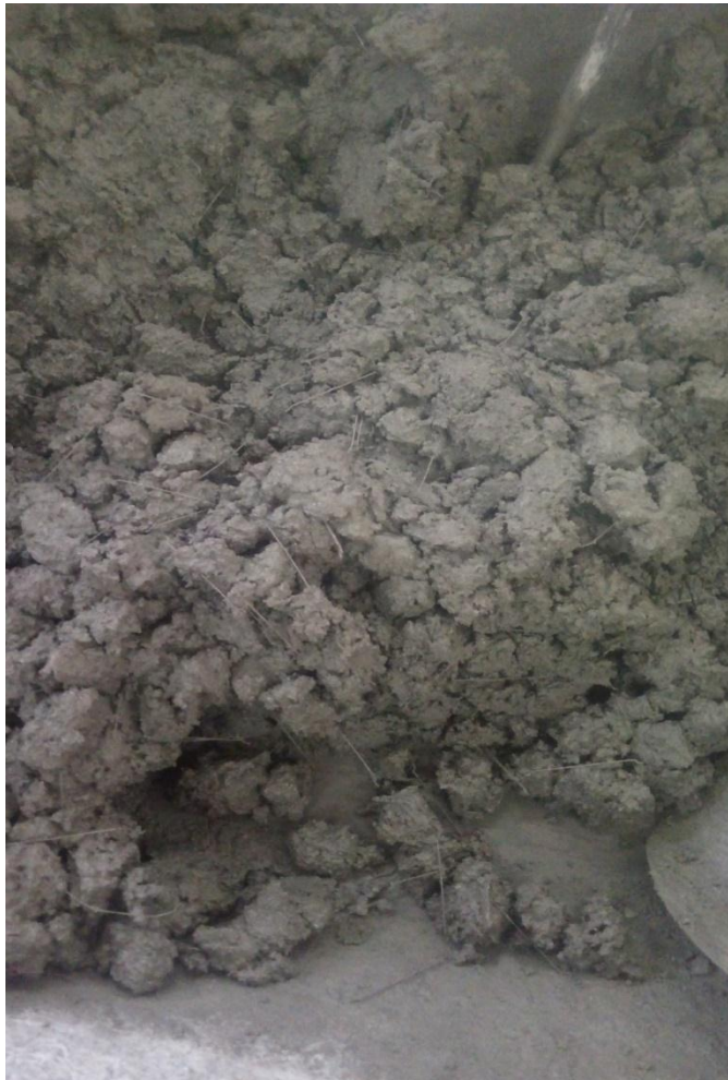
Figura 22. Mezcla de concreto del diseño con 35 kg/m 3 fibras de acero. Fuente: Propia.
