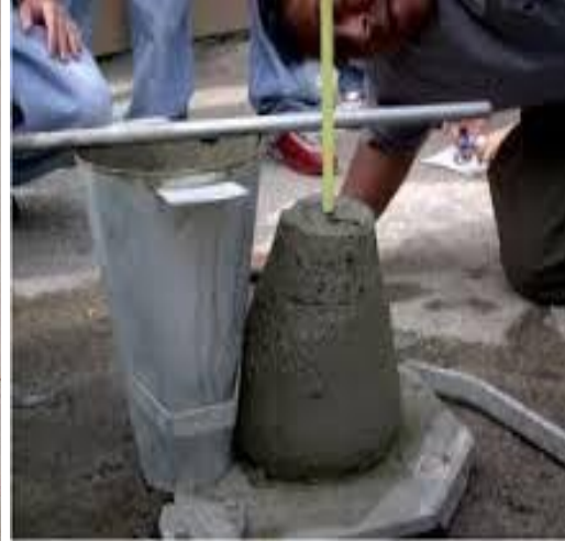
Figura 09. Asentamiento con fibra de Acero.
