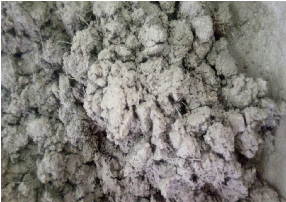
Figura 20. Mezcla de concreto del diseño con 20 kg/m 3 fibras de acero. Fuente: Propia.
