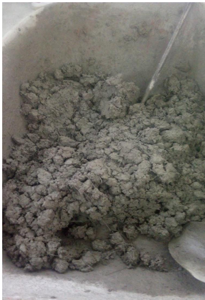
Figura 21. Mezcla de concreto del diseño con 25 kg/m 3 fibras de acero. Fuente: Propia.
