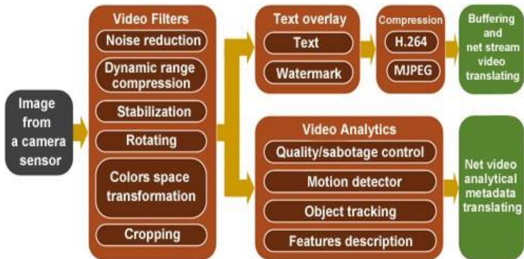
Figura 10: Óptimo pipeline para procesamiento digital de videos dentro de una cámara.
