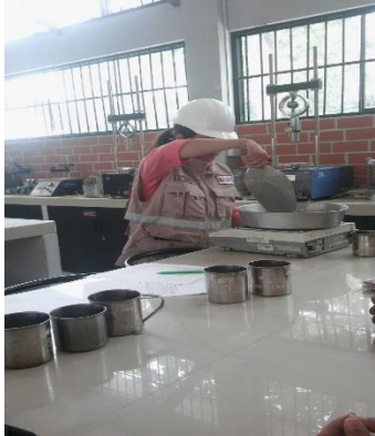
Se realiza ensayos de contenido de humedad
