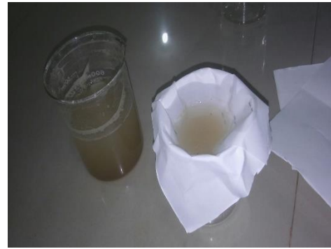
Se efectuó el ensayo de sales solubles de los agregados finos y gruesos.
