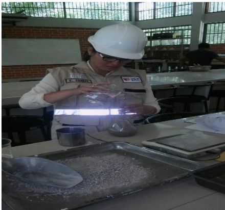
Se está realizando el ensayo de absorción de agregado fino
