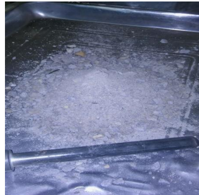
Se observa el material después de efectuarse los golpes en el cono de absorción
