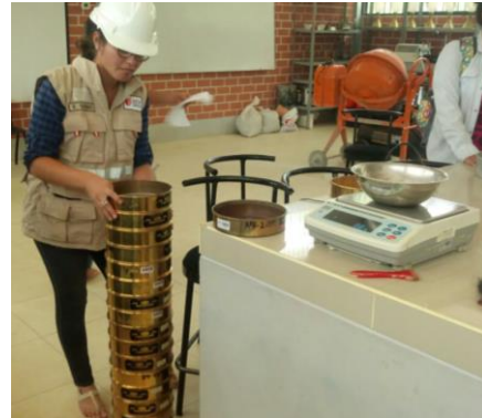
Se efectúa el ensayo de granulometría a los agregados reciclados
