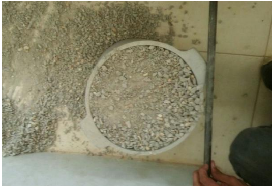
Se realizó el ensayo de peso unitario a los agregados de concreto reciclado
