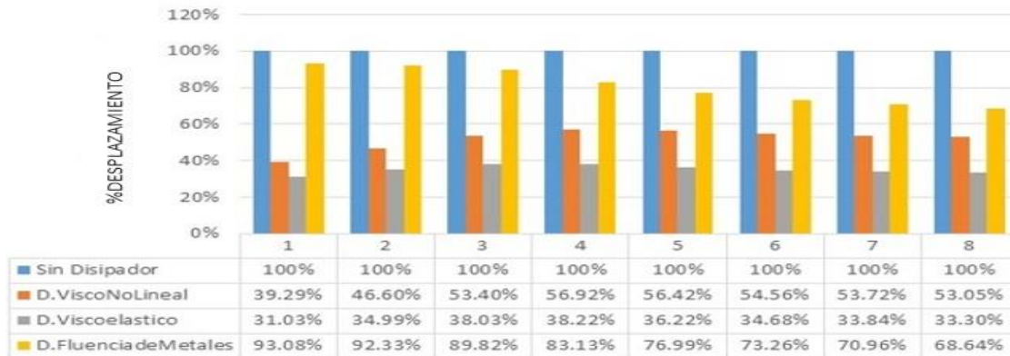
Figura 13 : Comparación de porcentaje de desplazamientos en X reducidos de la estructura con disipadores
