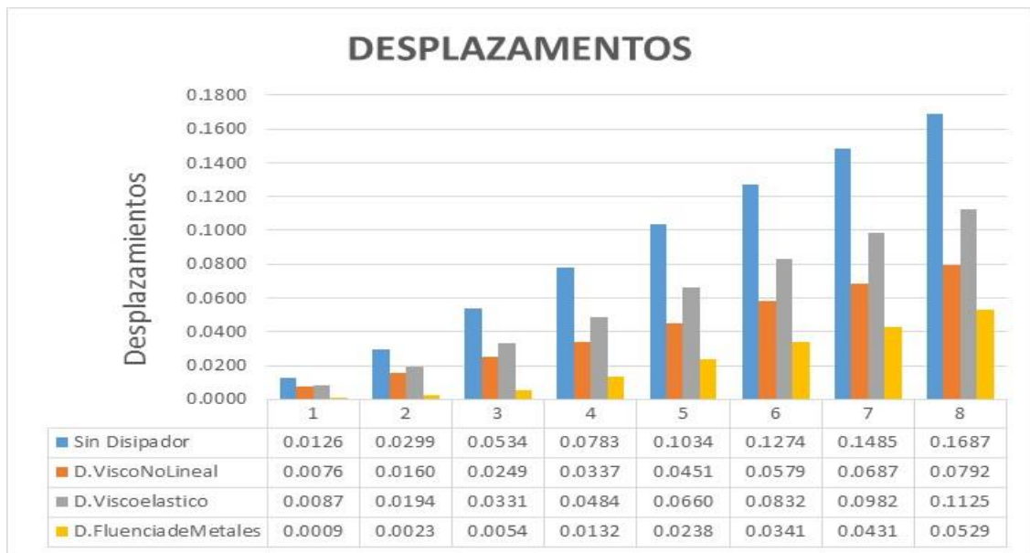
Figura 12 : Comparación de desplazamientos en X de la estructura sin y con disipadores
