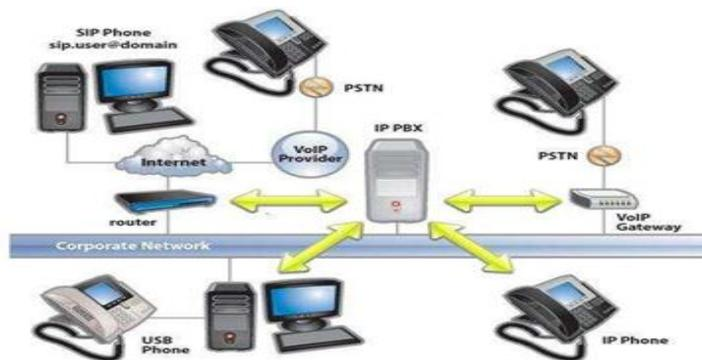
**Figura 4. Centralita telefónica voip**
