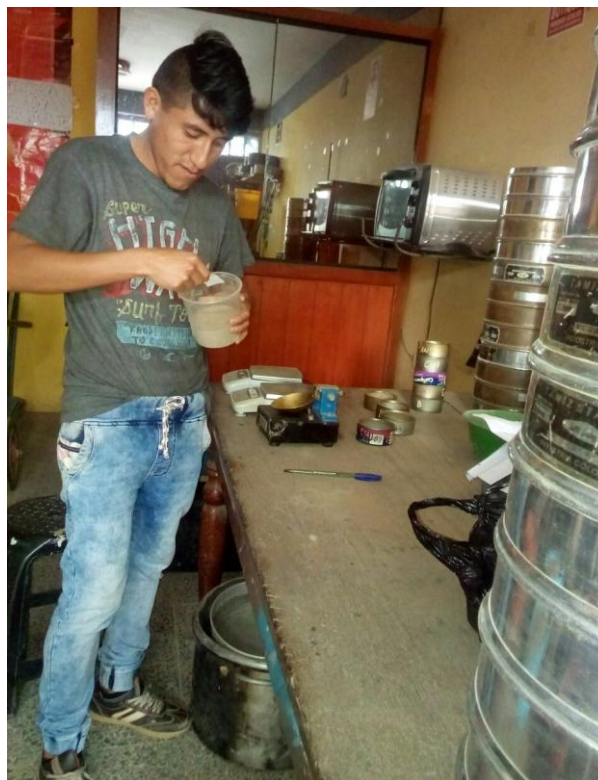
Fotografía N° 10: ensayo de límites de atterberg.
