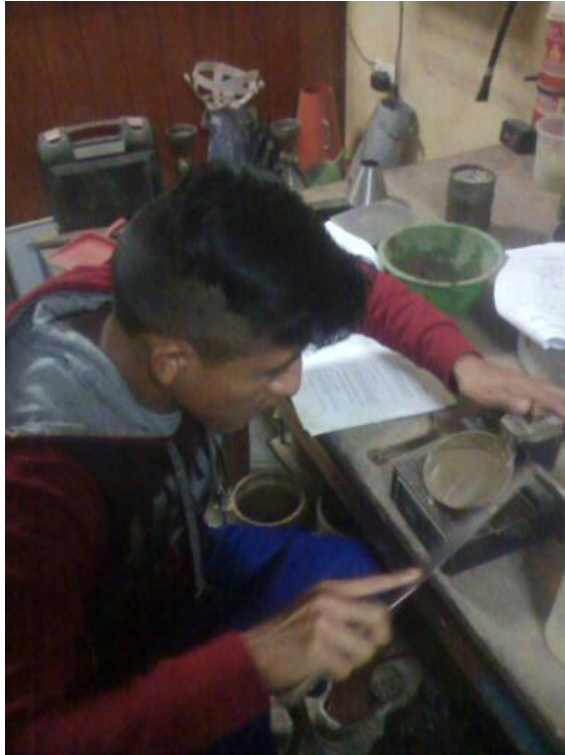
Fotografía N° 11: ensayo de límites de atterberg.
