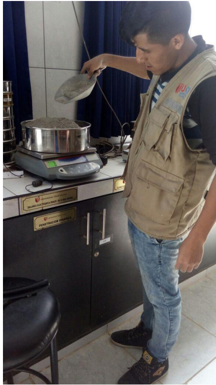
Fotografía N° 18: pesado de cemento para realizar la mezcla.
