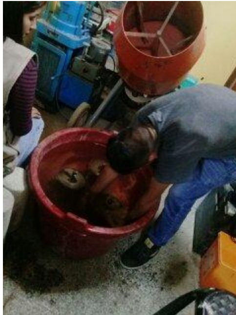
Fotografía N° 13: sumersión de la muestra al agua.
