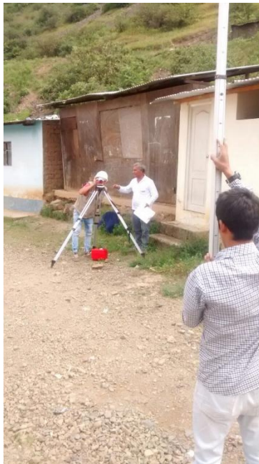
Fotografía N° 08: levantamiento topográfico en las calles de Lampanín
