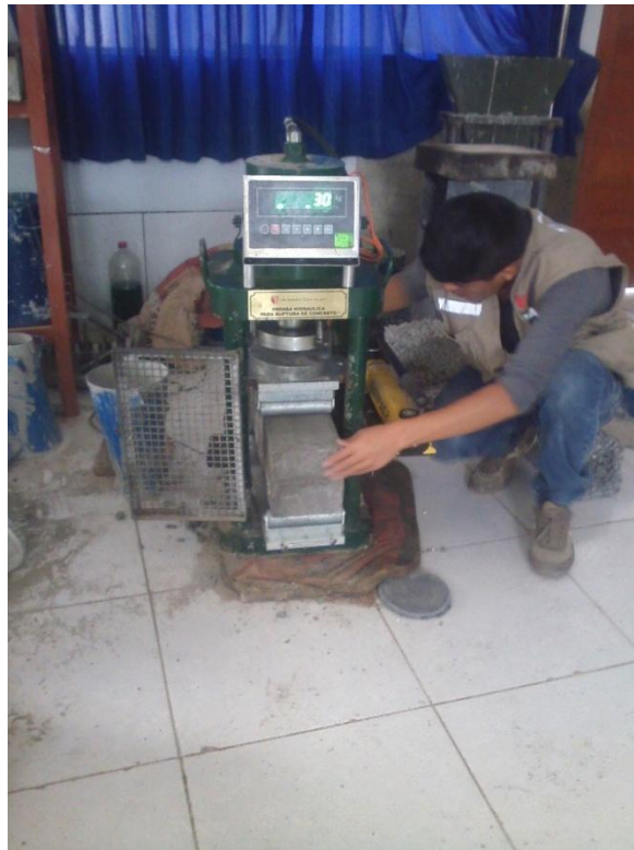
Fotografía N° 21: vigas sometidas a las cargas en sus tercios respectivamente.
