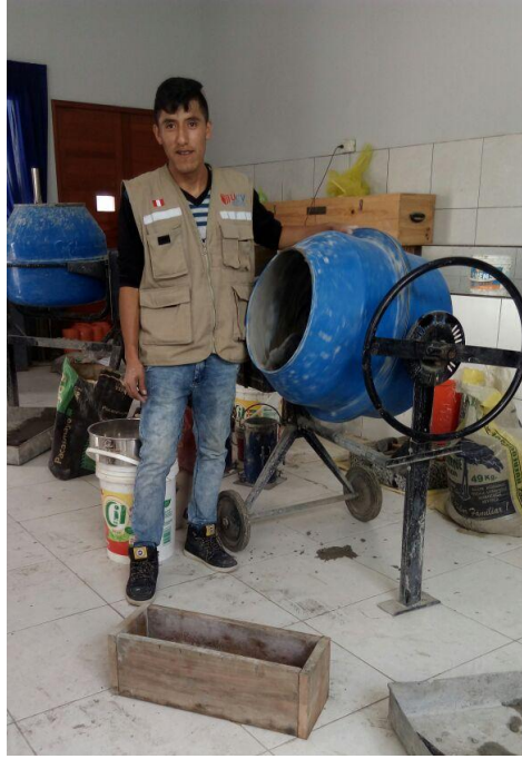
Fotografía N° 16: mezcla para ensayo de vigas a flexión.
