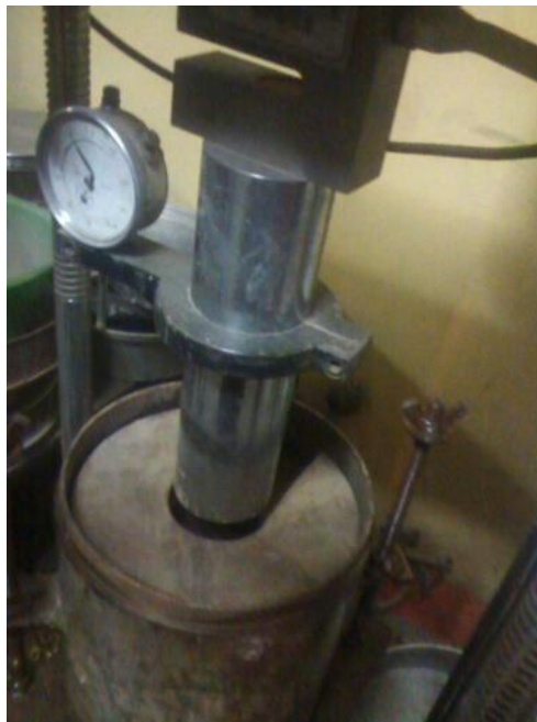
Fotografía N° 14: ensayo de CBR.
