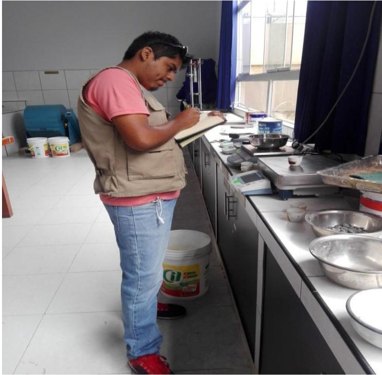
Figura Ñ-11: Se puede observar el pesado de las taras y el pesado de la tara más la muestra para la obtención del contenido de humedad.
