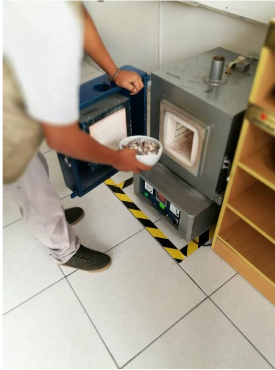
Figura N° 3 Se muestra la colocación de la Donax Sp en el horno mufla para su próxima calcinación.
