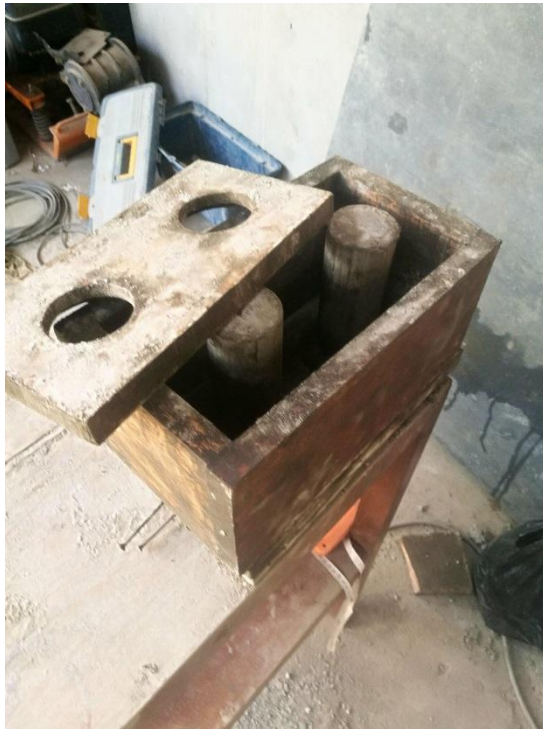
Figura N° 5 Se muestra el molde empleado para la fabricación de los ladrillos modulares.
