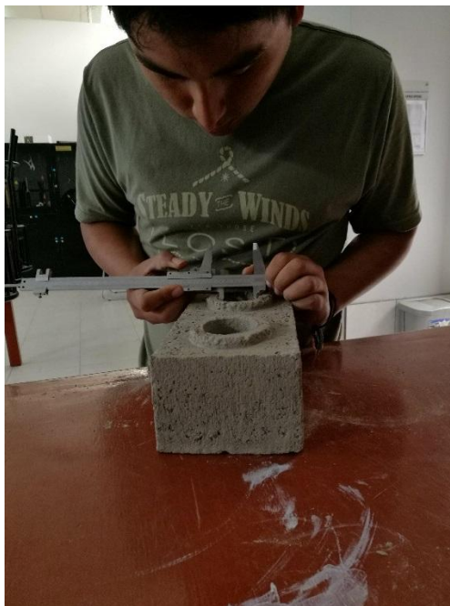
Figura N° 8 Se muestra el ensayo de variabilidad dimensional a los ladrillos modulares
