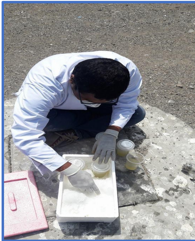
Fig.05 y Fig.06. Contenedor en donde se depositarán las muestras del agua residual tomadas
