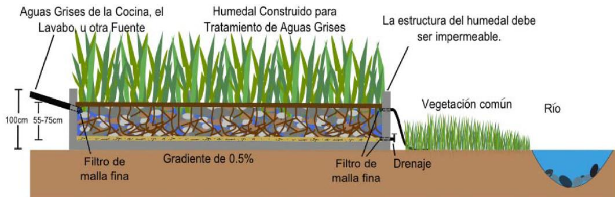
Figura 1. Un sistema subterráneo típico de humedales construidos
