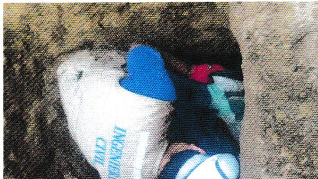
En la imagen se aprecia la toma de muestra aproximadamente 30 kg para realizar los ensayos correspondientes.
