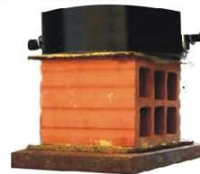
8.1.1 Se ensayarán medias unidades secas (véase 6.1.1), de ancho y altura equivalentes a las de la unidad original, y longitud igual a media unidad  $\pm$  25 mm. Si la capacidad de resistencia del espécimen excede la capacidad de la máquina, se podrá ensayar piezas menores, con altura y espesor de la unidad original y longitud no menor de  $\frac{1}{4}$  de la longitud total de la unidad, y con un área de sección horizontal bruta no menor de 90 cm<sup>2</sup>.
