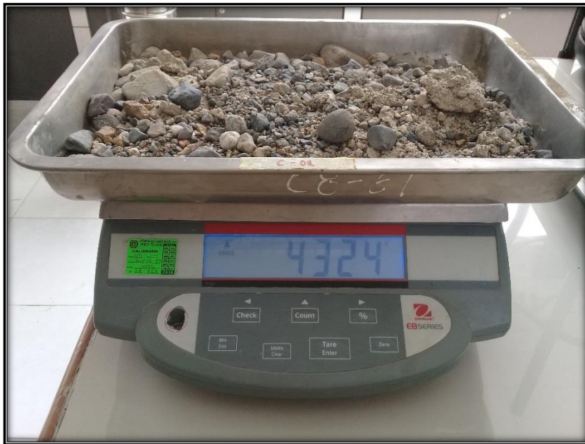
La muestra C-2 es pesada con tara.
