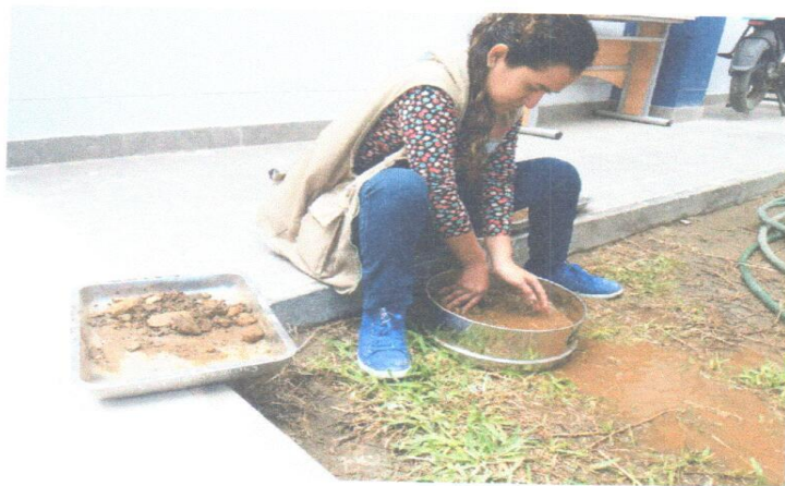
En la imagen se aprecia el proceso de lavado de la muestra para luego ser secada para poder obtener datos exactos en la granulometría.
