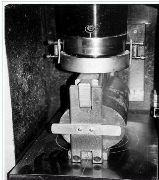
Figura 3. Cilindro colocado para ensayo de tensión indirecta
