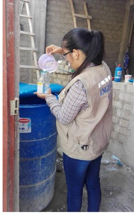
*IMAGEN 16: Toma de muestra de agua para el análisis físico – químico y bacteriológico del agua.*
