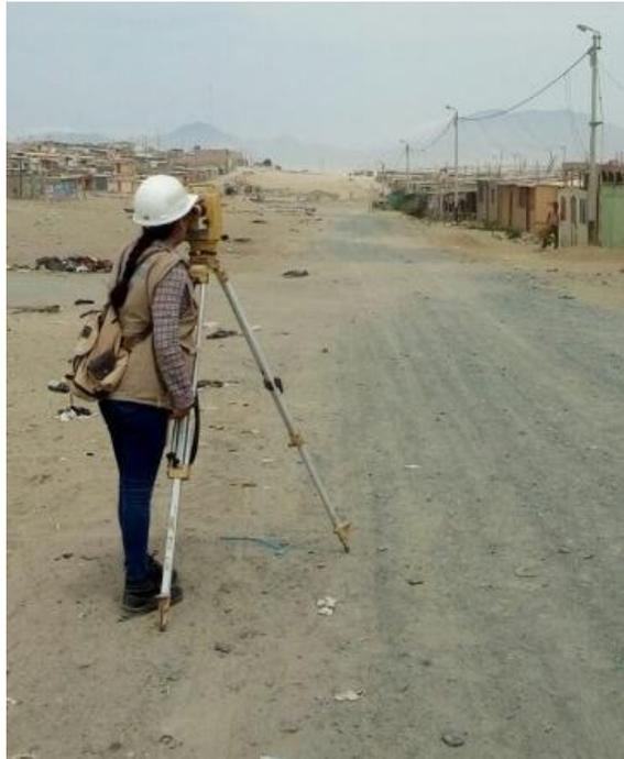
*IMAGEN 03: Levantamiento Topográfico con la estación total en el Asentamiento Humano Nueva Esperanza.*
