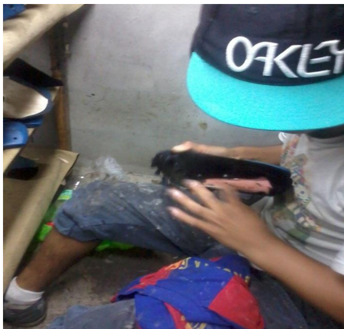
Figura 33. Echando pegamento para pegar el Neolite Fuente: Empresa Inversiones y Creaciones E.I.R.L.
