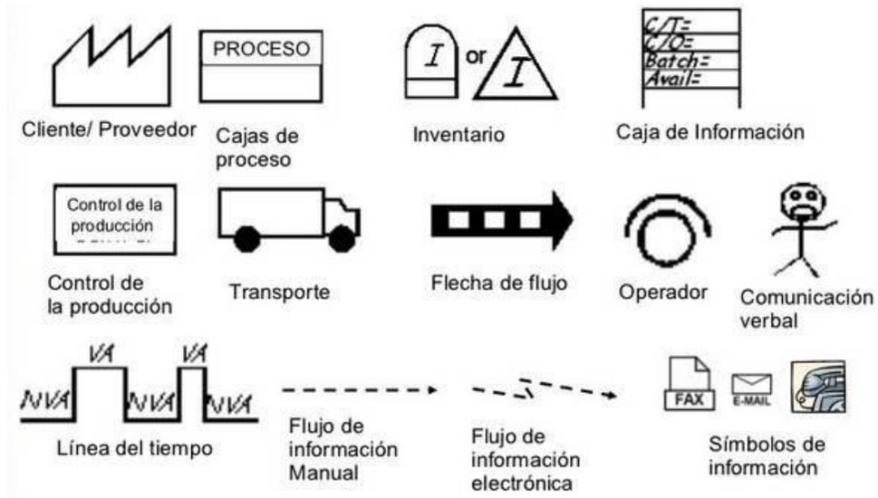
Figura 4: Iconos utilizados en el VSM para flujos de materiales.
