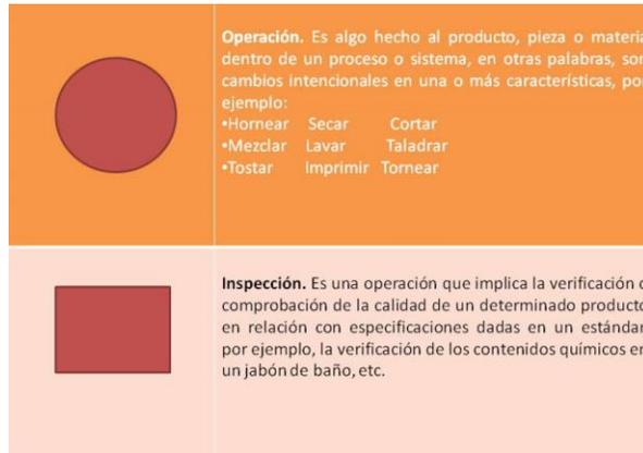
**Figura 10:** Símbolos del diagrama de operaciones del proceso
