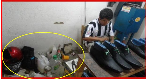
En esta imagen se puede apreciar que existen elementos que no deben estar dentro de esta área de armado, como son botellas de plásticos, un casco de motocicleta, papeles, y una mochila, lo cual necesita urgente una clasificación de todos estos elementos.
