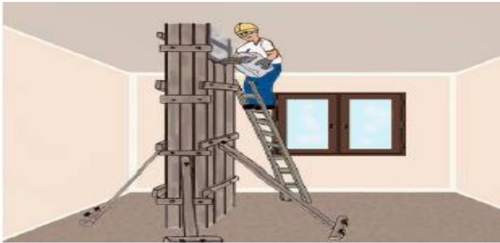
Figura 108. Verter el concreto con la ayuda de una escalera (Fuente: Silva 2014)
