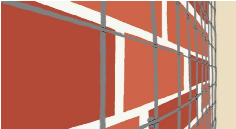
Figura 114. Perforar a cada 45 cm, especialmente en lo nudos (Fuente: Silva 2014)
