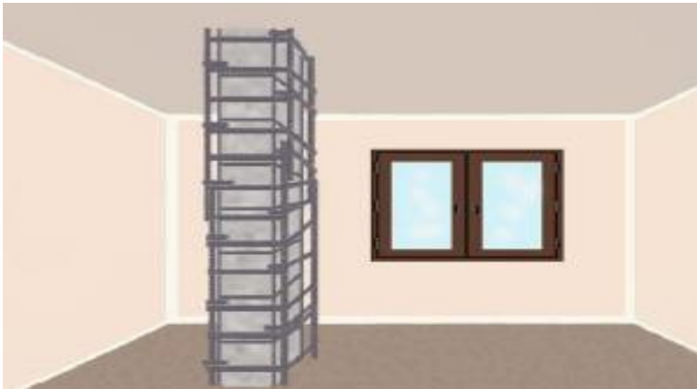
Figura 106. Colocar los estribos de la columna ( Fuente: Silva 2014)
