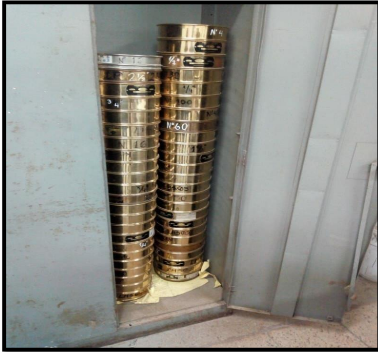
Instrumentos para el análisis granulométrico (tamices)
