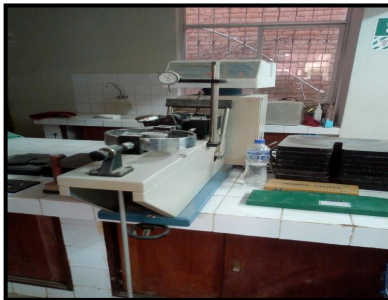
Aparato para el ensayo de corte directo
