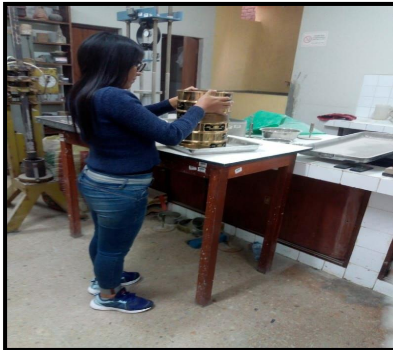
Cribado de la muestra con los tamices
