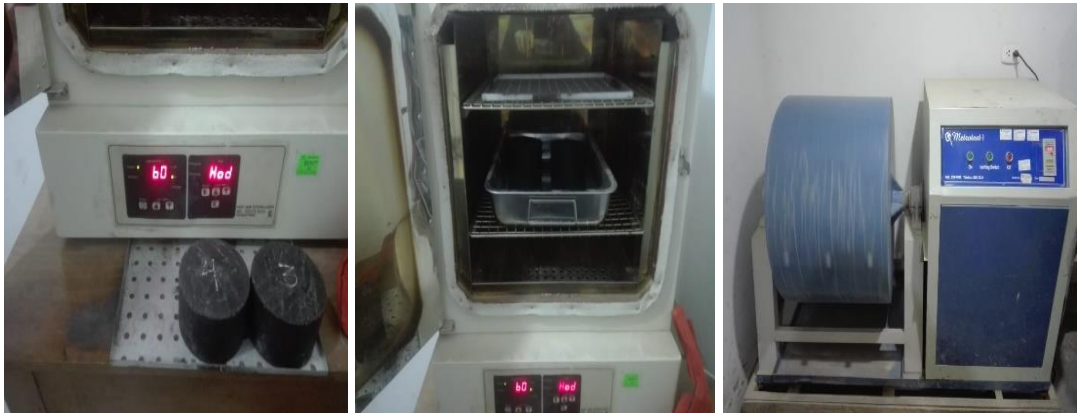
Figura 19. Horno calibrado a la temperatura de ensayo de durabilidad.
