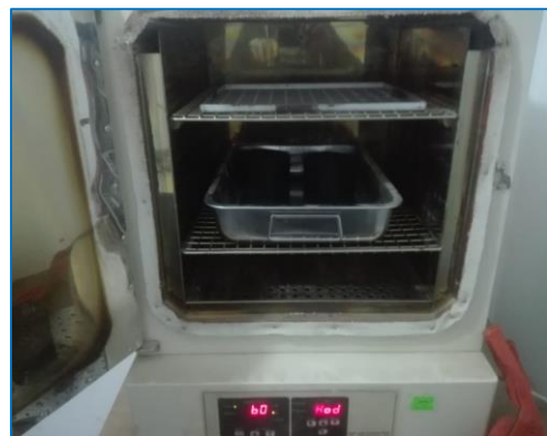
Horno graduada a 60 °C para envejecimiento de probeta.
