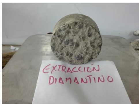
Figura 13. Núcleo de la capa de rodadura. Fuente: Elaboración propia.
