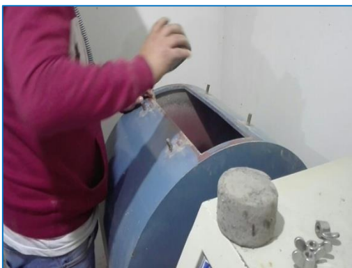
Probetas ensayadas en la máquina de los ángeles.
