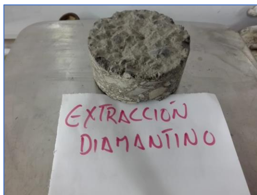
Descripción: núcleo del asfalto extraído en el laboratorio.
