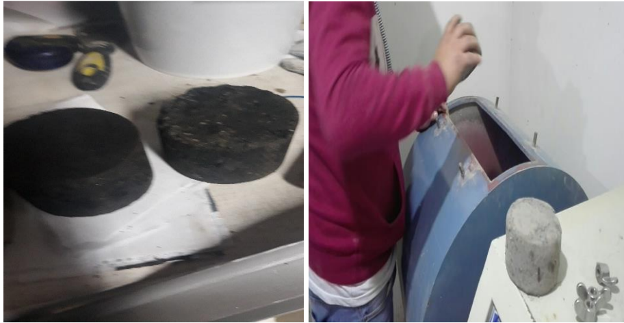
Figura 17. Probetas listas para ser ensayadas en la máquina de los Ángeles. Fuente: Elaboración propia.
