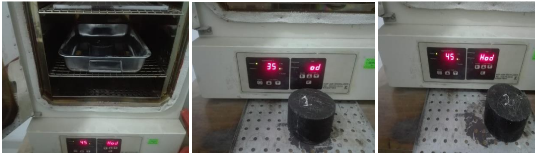
Figura 15. Horno calibrado a la temperatura de ensayo de susceptibilidad térmica.
