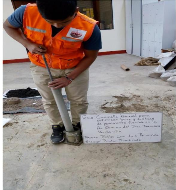
Ensayo de proctor modificado
