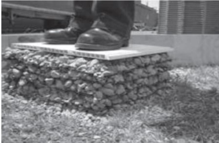
*Figura 5. Confinamiento lateral en material granular*
