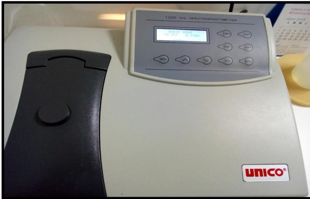
Figura 36. Estandarización del inóculo por espectrofotometría en absorbancias. FUENTE: Propia
