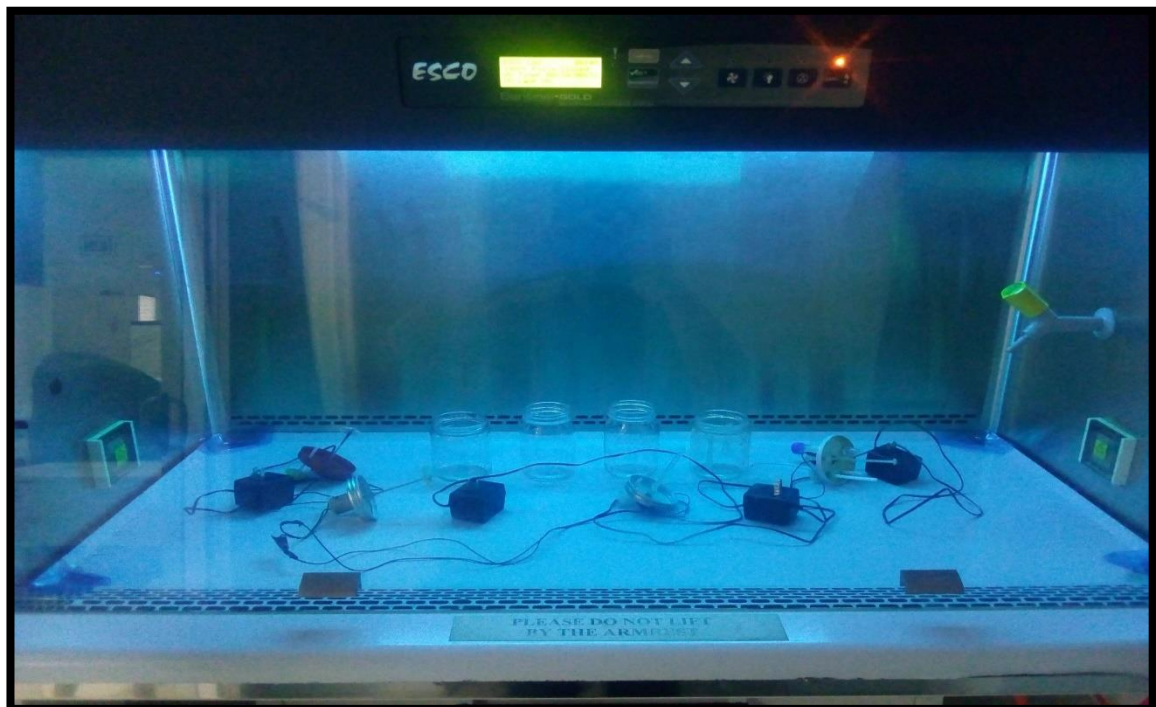
Figura 31. Esterilización de biorreactores por radiación UV. FUENTE: Propia
