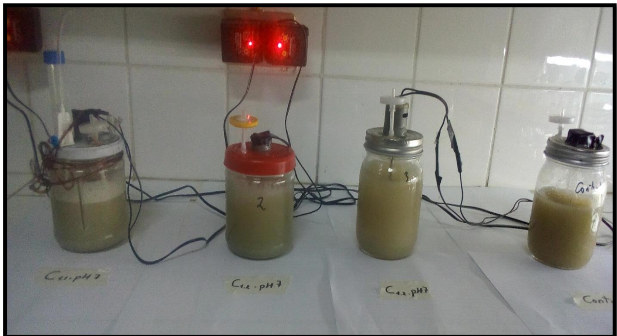
Figura 37. Proceso de biorremediación del efluente pesquero a 3 \times 10^8 UFC/ml de halófilo y a pH 7. FUENTE: Propia
