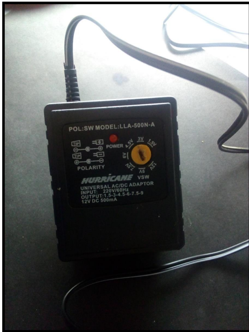
Figura 13. Modelo del convertidor de voltaje para el biorreactor de batch discontinuo. FUENTE: Propia
