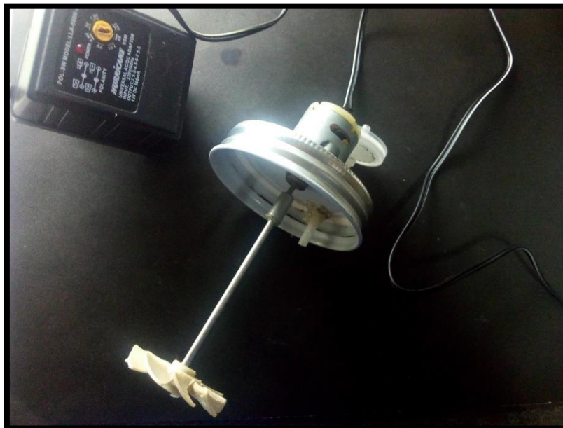
Figura 12. Tapa del biorreactor con el motor pegado. FUENTE: Propia
