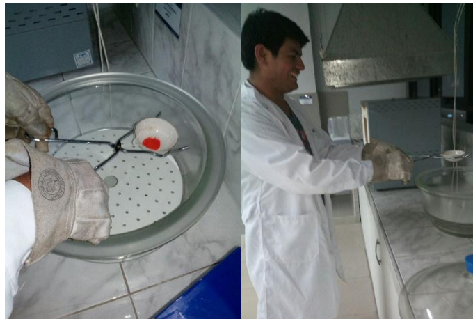
Figura 14. Enfriamiento de la sal de dicromato de potasio
