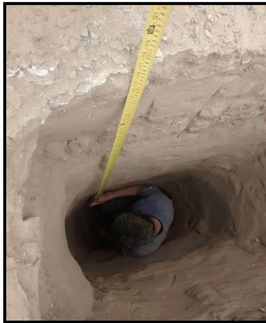
Figura 123: Excavación de calicata C-1 Fuente: Elaboración propia
