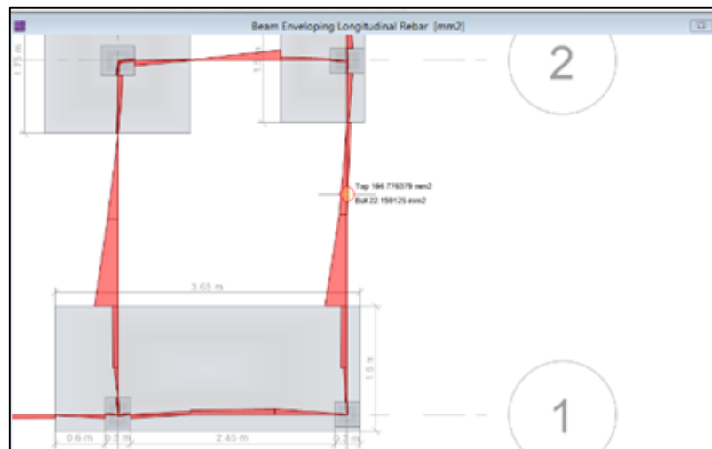
Figura 104: Área de refuerzo para vigas de cimentación
