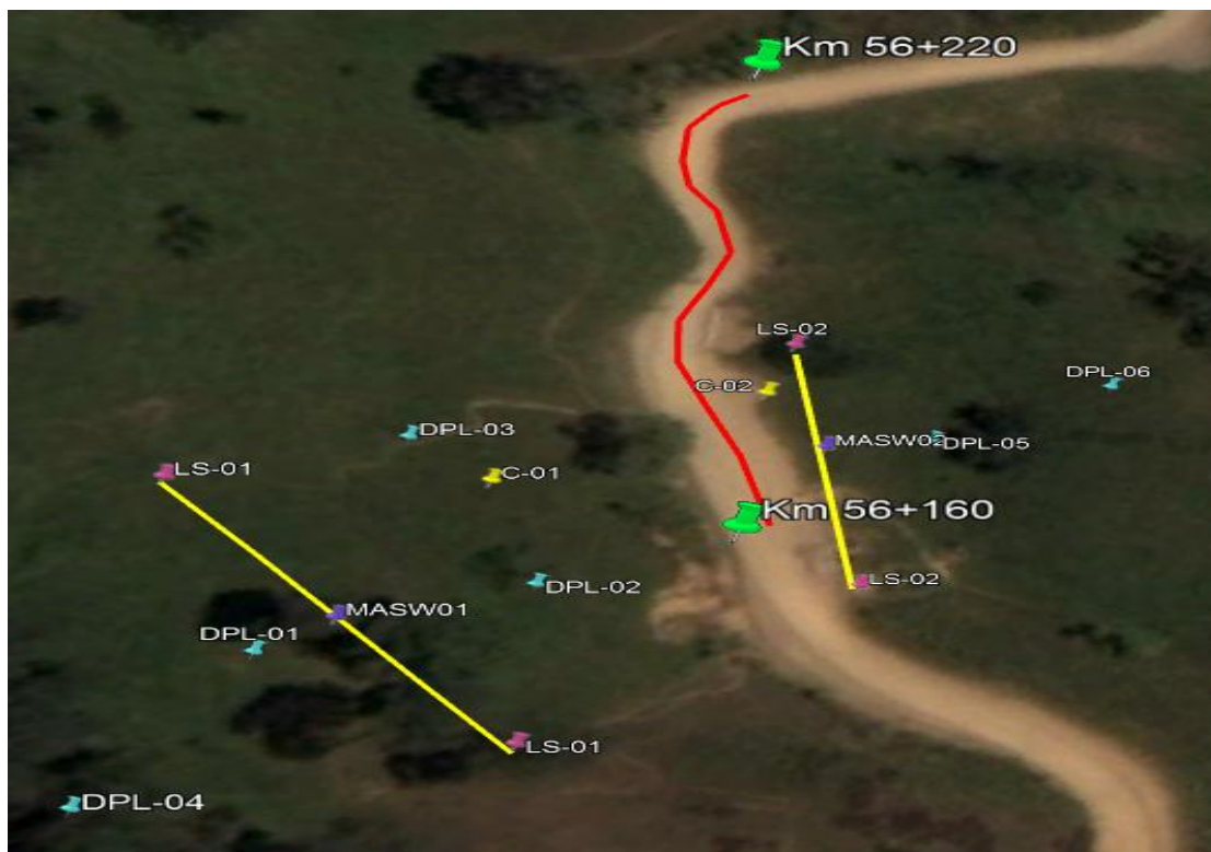
Figura 3.6: ensayos geotécnicos y geofísicos ejecutados en el sector inestable Fuente: adaptado de (google earth)
