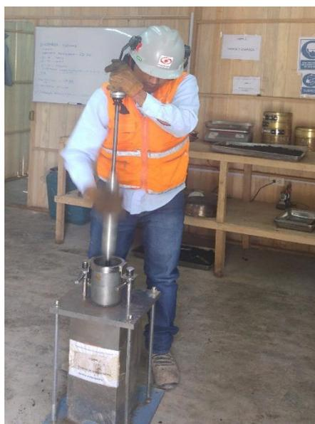
*Figura 18.* Compactación de Mezcla Asfáltica en Caliente con el martillo sobre el pedestal de compactación-Diseño Método Marshall.
