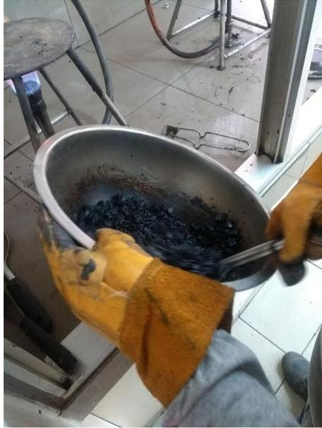
*Figura 40.* Calentamiento de la Mezcla de agregados con el cemento asfáltico
