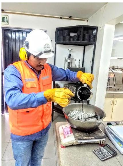
**Figura 39.** Dosificación de agregados con cemento asfáltico Pen 85/100 aditivado
