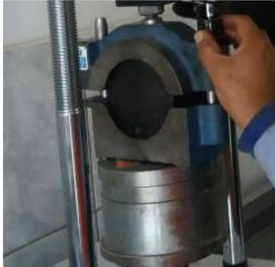
*Figura 21. Briqueta y mordazas acondicionadas en la Prensa Marshall para el ensayo de Estabilidad y fluencia – Diseño Método Marshall*
