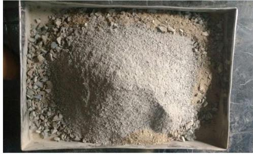
Figura 10. Mezcla total de agregados (combinación física)-Diseño Método Marshall
