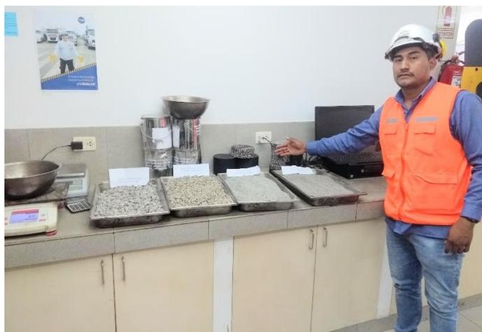
*Figura 36. Agregados para elaboración de testigos de asfalto
