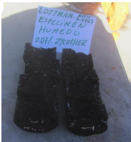
Figura 35. Testigos de Asfalto-Grupo Húmedo Después del Ensayo Lottman
