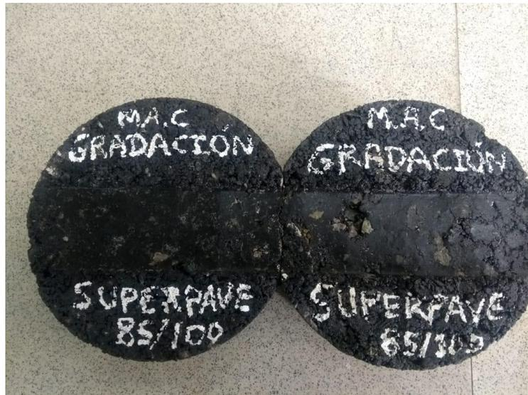
Figura 46. Testigos de asfalto fallados después del ensayo de la Rueda de Hamburgo
