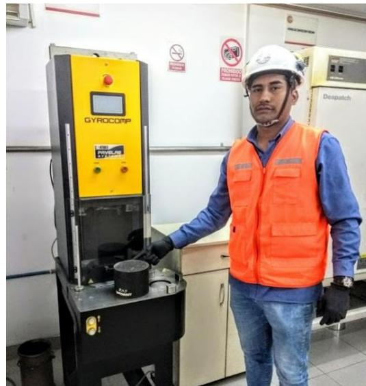
*Figura 42. Equipo Compactador Giratorio Superpave (SGC)
