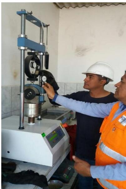
*Figura 22.* Ensayo de Estabilidad y fluencia en el equipo Prensa Marshall – Diseño Método Marshall
