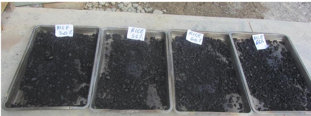
*Figura 19.* Muestras de mezcla para ensayo de Máxima Densidad Teórica (RICE) por cada porcentaje de cemento asfáltico-Diseño Método Marshall
