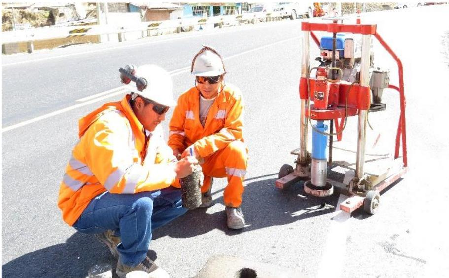
*Figura 5. Extracción e identificación de un testigo de asfalto*
