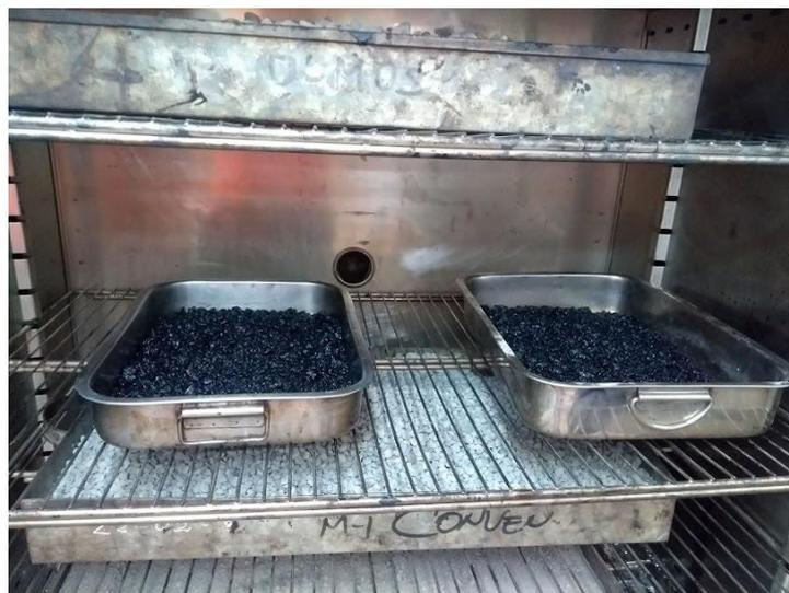
*Figura 41.* Mezcla Asfáltica en Caliente en horno para curado por 4 horas
