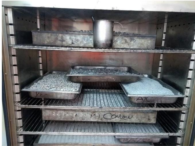
*Figura 37.* Agregados secando en el horno para elaboración de testigos de asfalto
