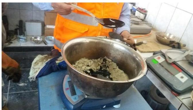
*Figura 17.* Peso de cemento asfáltico para el porcentaje deseado-Diseño Método Marshall
