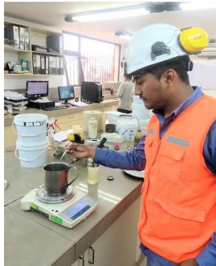
*Figura 38.* Aditivado del cemento asfáltico Pen 85/100 con 0,07 % de aditivo zycotherm
