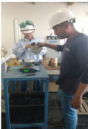
*Figura 16.* Peso de agregados para la elaboración de las briquetas-Diseño Método Marshall
