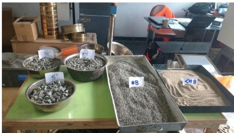
Figura 14. Agregados pétreos -Diseño Método Marshall
