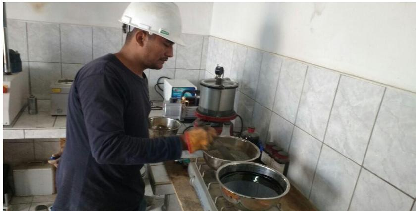
Figura 15. Calentamiento de agregados y asfalto para la elaboración de las briquetas-Diseño Método Marshall
