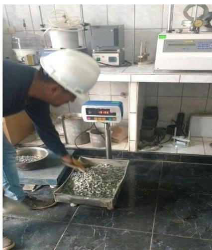
*Figura 9. Pesaje de agregados para combinación física-Diseño Método Marshall.
