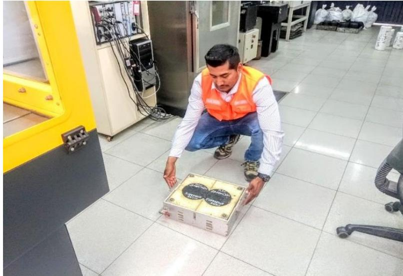
*Figura 44. Testigos de Asfalto acondicionados para el ensayo en la Rueda de Hamburgo*
