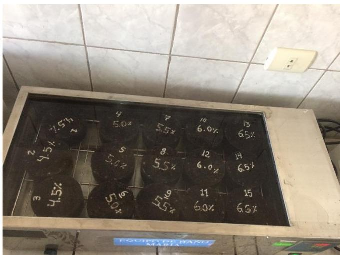
Figura 20. Briquetas en Baño maría a 60 ° C - Diseño Método Marshall
