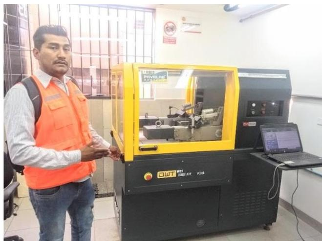
*Figura 45. Equipo de Rueda Hamburgo en funcionamiento realizando el ensayo*
