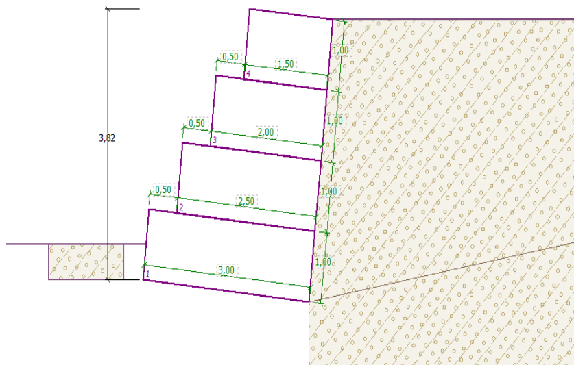
Figura 19. Geometría final del gavión. (Fuente: Elaboración propia, 2018)
