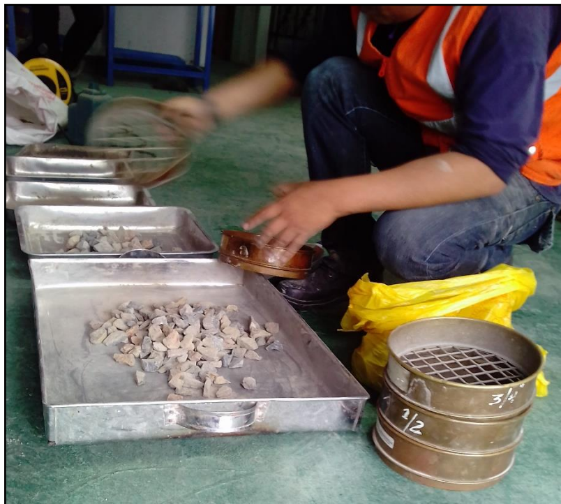
Figura 49. Preparación para el ensayo de abrasión. (Fuente: Elaboración propia, 2018)
