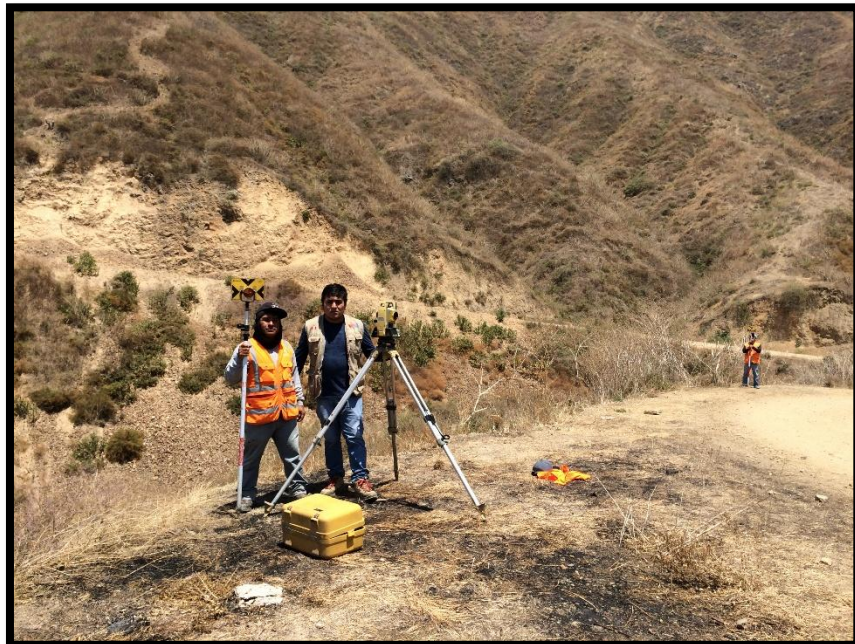
Levantamiento topográfico con estación total.
