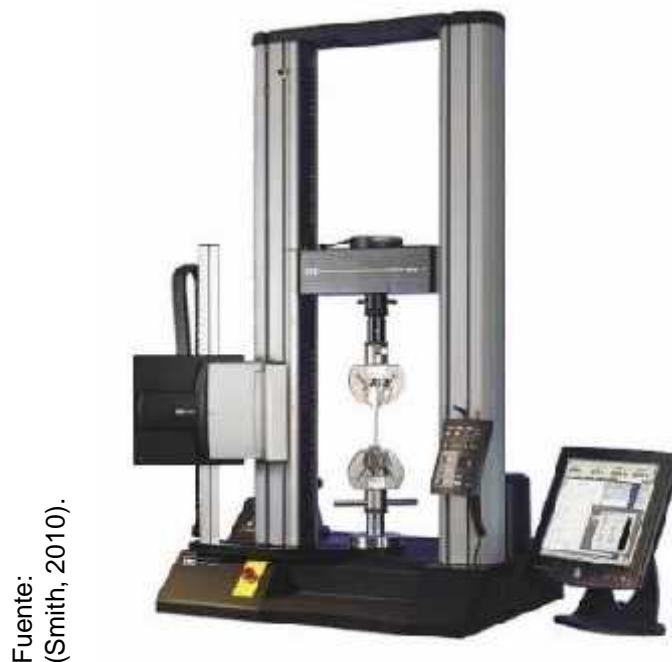
Máquina universal de tracción
