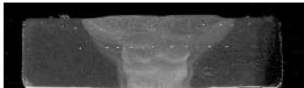
Dureza y macroestructura a en el cordón de soldadura del acero ASTM A36. Los pases de soldadura fueron (a) 1 pasada (b) 2 pasadas. Y (c) 3 pasadas
