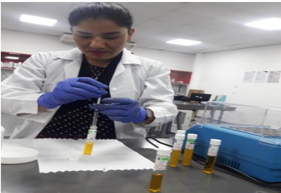
Imagen 14: REALIZACIÓN D EL PROCEDIMIENTO DE LAS MUESTRAS DE AGUAS TRATADAS POR VERMIFILTROS PARA DETERMINAR EL DQO
