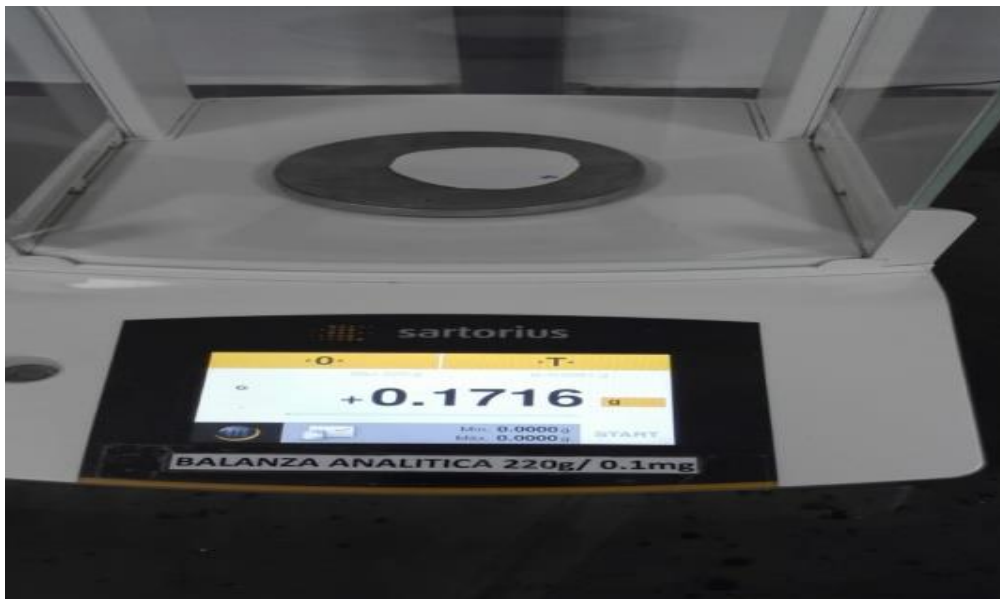
Imagen 13: PESO DE LOS FILTROS SECOS PARA DETERMINAR LOS SOLIDOS SUSPENDIDOS TOTALES
