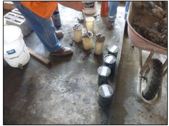
Foto N°21. Preparación de las probetas cilíndricas para que pasen el ensayo de resistencia de compresión.
