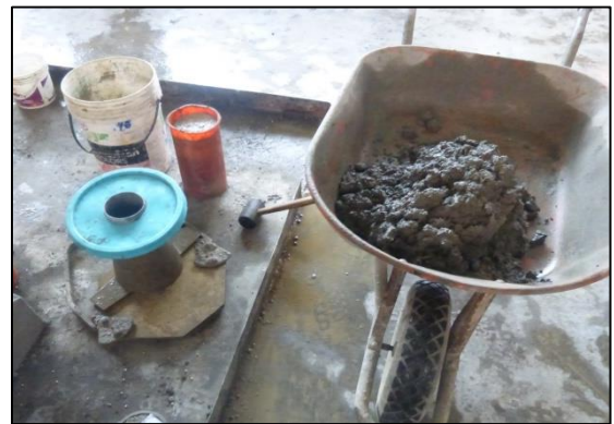
Foto N°16. Ensayo del Cono de Abrams, preparación de la mezcla y preparación para colocado al cono para determinar el asentamiento.
