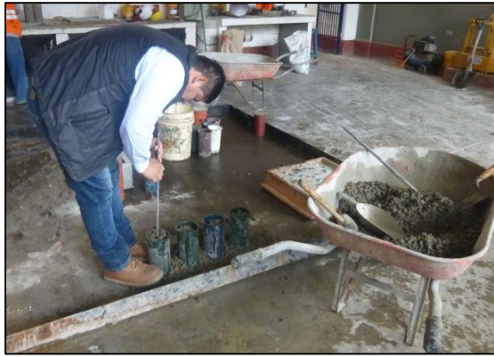
Foto N°21. Preparación de las probetas cilíndricas para que pasen el ensayo de resistencia de compresión.
