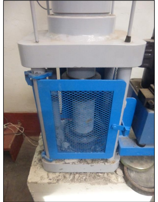
Foto N°31. Colocado de la probetas cilíndricas de arena gruesa reciclada a la máquina de resistencia de compresión del laboratorio.
