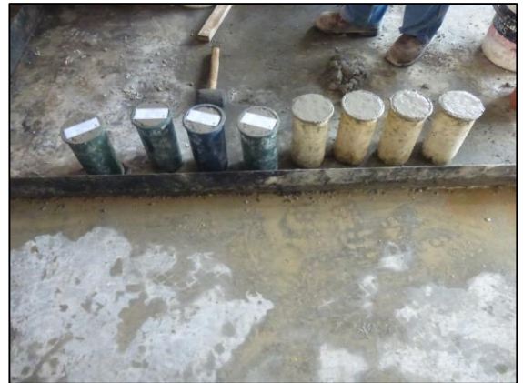
Foto N°22. Preparación de las probetas cilíndricas para que pasen el ensayo de resistencia de compresión y colocado de la etiqueta.
