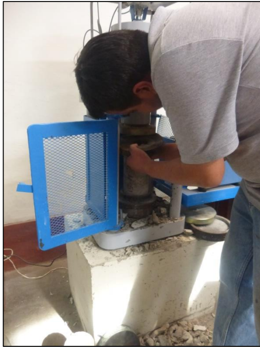
Foto N°31. Colocado de la probetas cilíndricas de arena gruesa reciclada a la máquina de resistencia de compresión del laboratorio.
