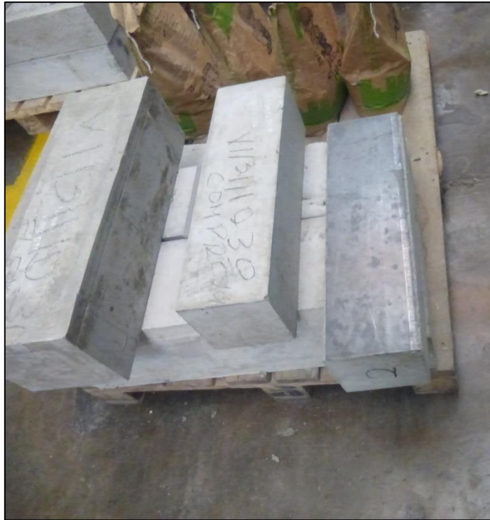
Foto N°37. Probetas Tipo Viga, elaboradas a base de Arena Gruesa Reciclada.
