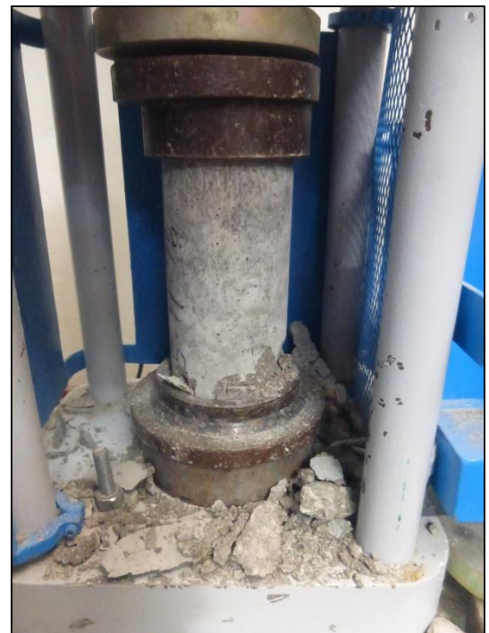
Foto N°34. Probetas cilíndricas ya ensayadas y su falla de rotura, que presenta la probeta hecho a base de arena fina natural.
