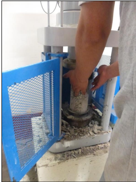
Foto N°33. Colocado de la probetas cilíndricas de arena gruesa natural a la máquina de resistencia de compresión del laboratorio.
