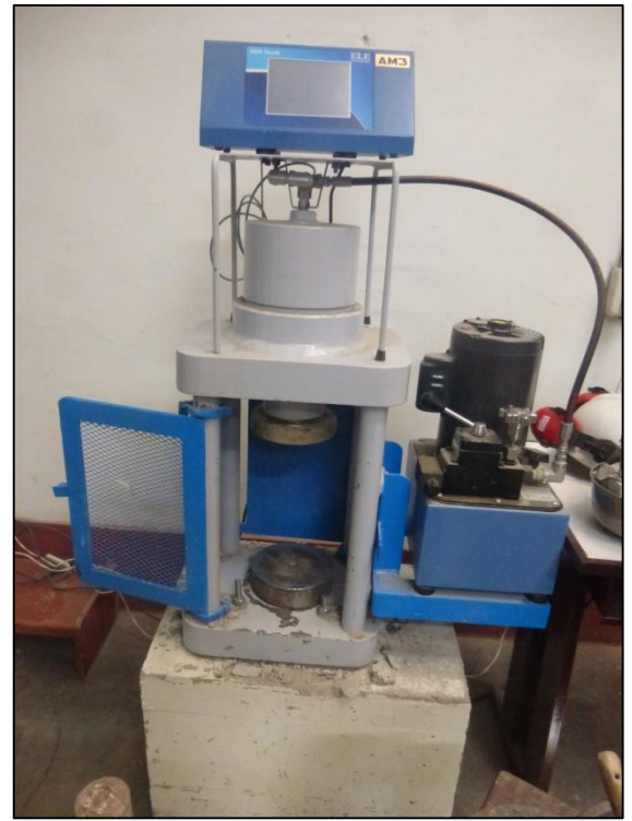
Foto N°29. Máquina para ensayo de resistencia de compresión en el laboratorio.
