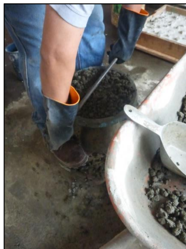
Foto N°17. Ensayo del Cono de Abrams, colocación de la mezcla al cono de abrams para determinar la medición del asentamiento de la mezcla.
