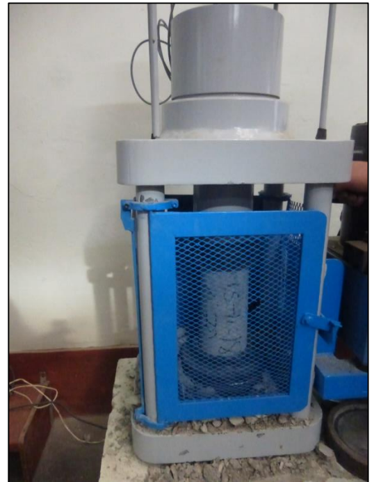
Foto N°33. Colocado de la probetas cilíndricas de arena gruesa natural a la máquina de resistencia de compresión del laboratorio.
