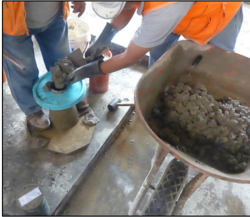
Foto N°18. Ensayo del Cono de Abrams, colocación de la mezcla al cono de abrams para determinar la medición del asentamiento de la mezcla.
