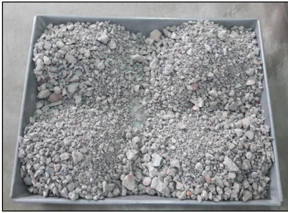
Foto N°11. Ensayo Granulométrico – cuarteo y pesaje de la muestra de la arena gruesa reciclada-
