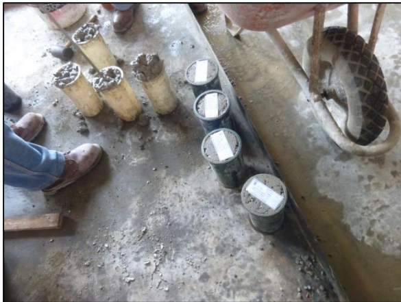
Foto N°22. Preparación de las probetas cilíndricas para que pasen el ensayo de resistencia de compresión y colocado de la etiqueta.
