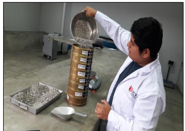
Foto N°13. Colocación de la muestra en los tamices granulométricos.
