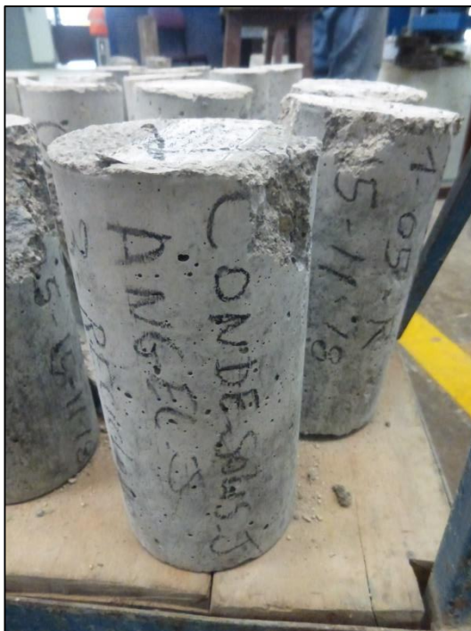
Foto N°34. Probetas cilíndricas ya ensayadas y su falla de rotura, que presenta la probeta hecho a base de arena fina natural.
