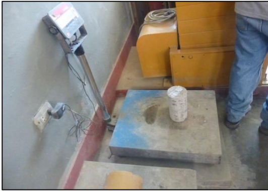
Foto N°26. Pesaje de las Probetas cilíndricas con Agregado Fino Natural y Agregado Fino Reciclado.
