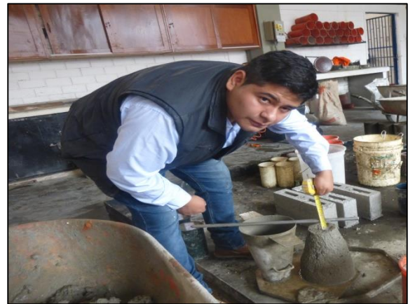
Foto N°19. Ensayo del Cono de Abrams, medición del asentamiento en pulgadas para determinación de la consistencia de la mezcla.
