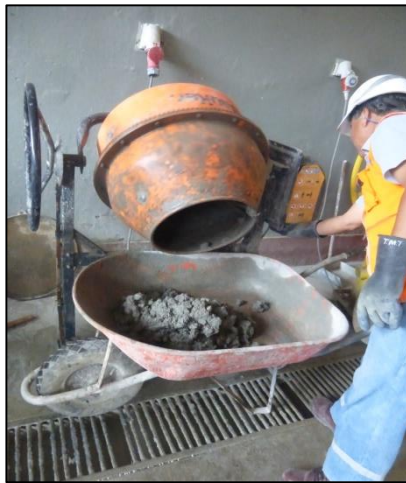
Foto N°16. Ensayo del Cono de Abrams, preparación de la mezcla y preparación para colocado al cono para determinar el asentamiento.
