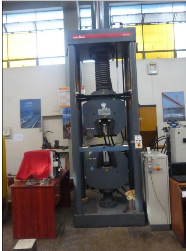
Foto N°35. Máquina para ensayo de resistencia de flexión en el laboratorio.
