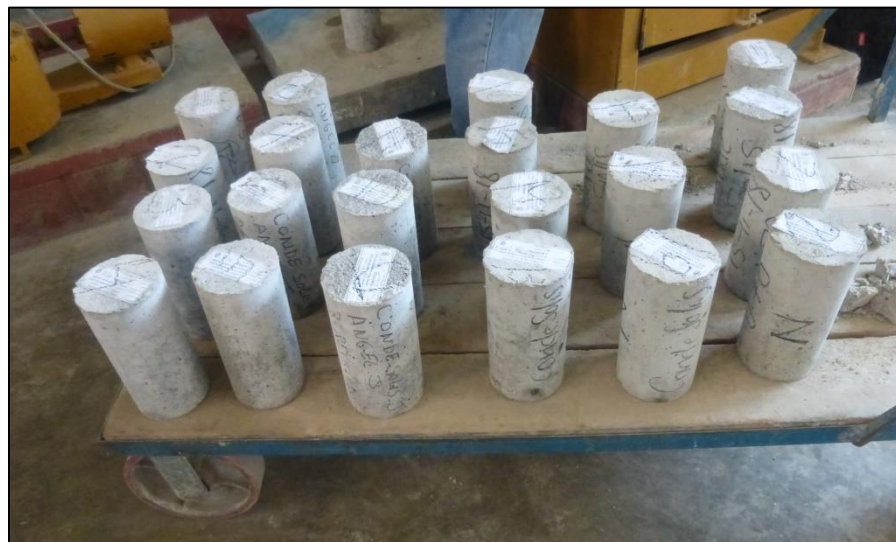
Foto N°23. Probetas listas para el ensayo de compresión.
