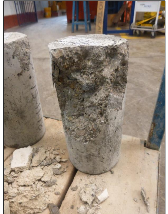
Foto N°32. Probetas cilíndricas ya ensayadas y su falla de rotura, que presenta la probeta hecho a base de arena fina reciclada.
