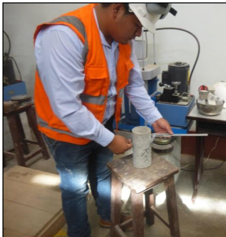
Foto N°30. Medición de las Probetas cilíndricas, con vernier.
