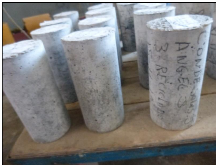
Foto N°27. Probeta cilíndrica de arena gruesa reciclada, tiene un color plomo.
