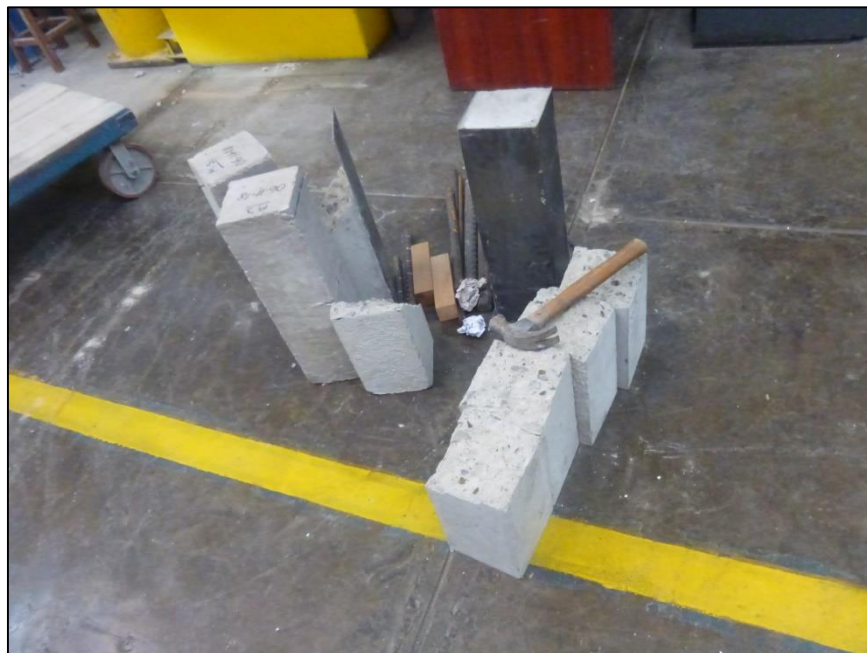
Foto N°38. Probetas Tipo Viga ya ensayadas y su falla de rotura, que presenta la probeta hecho a base de arena fina reciclada y natural.
