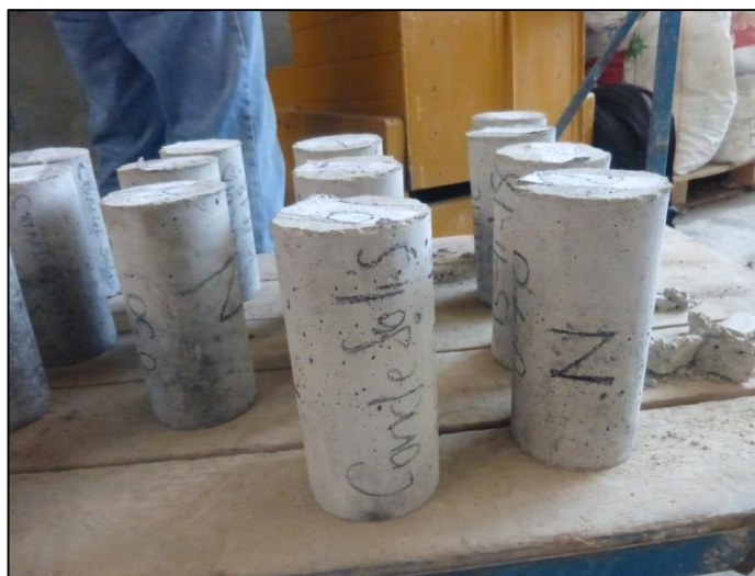
Foto N°28. Probeta cilíndrica de arena gruesa natural, tiene un color gris.
