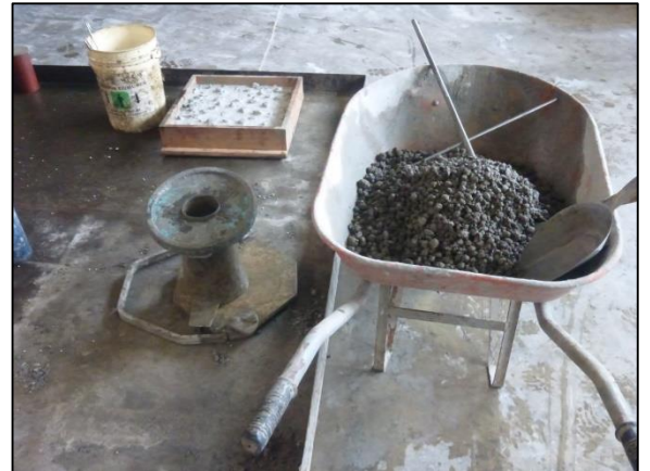
Foto N°15. Ensayo del Cono de Abrams, preparación de la mezcla y preparación para colocado al cono para determinar el asentamiento.
