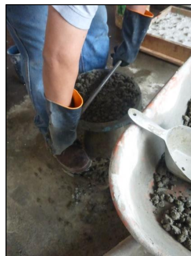
Foto N°17. Ensayo del Cono de Abrams, colocación de la mezcla al cono de abrams para determinar la medición del asentamiento de la mezcla.
