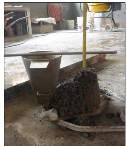
Foto N°20. Ensayo del Cono de Abrams, medición del asentamiento en pulgadas para determinación de la consistencia de la mezcla.
