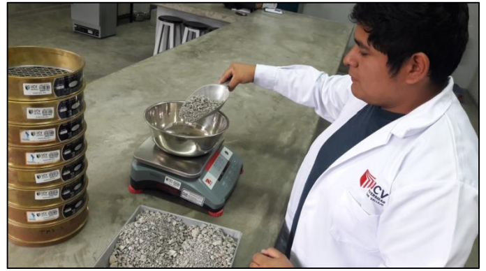
Foto N°11. Ensayo Granulométrico – cuarteo y pesaje de la muestra de la arena gruesa reciclada-
