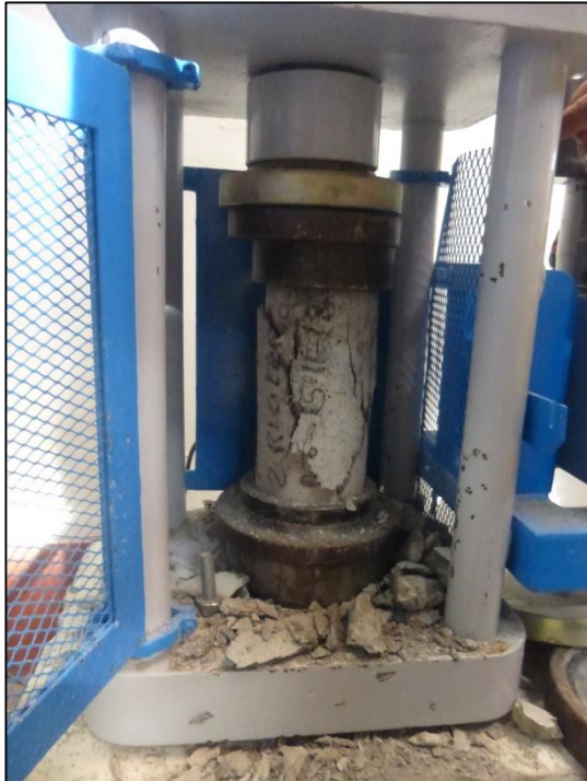
Foto N°32. Probetas cilíndricas ya ensayadas y su falla de rotura, que presenta la probeta hecho a base de arena fina reciclada.
