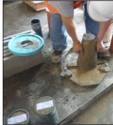
Foto N°18. Ensayo del Cono de Abrams, colocación de la mezcla al cono de abrams para determinar la medición del asentamiento de la mezcla.
