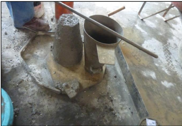
Foto N°19. Ensayo del Cono de Abrams, medición del asentamiento en pulgadas para determinación de la consistencia de la mezcla.
