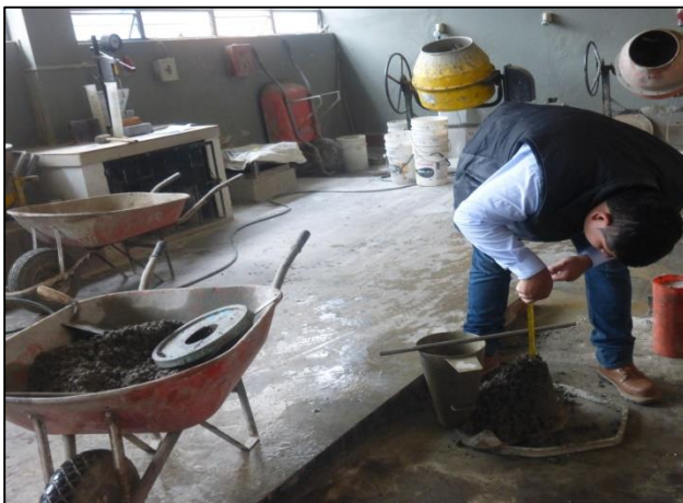
Foto N°20. Ensayo del Cono de Abrams, medición del asentamiento en pulgadas para determinación de la consistencia de la mezcla.
