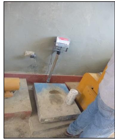
Foto N°26. Pesaje de las Probetas cilíndricas con Agregado Fino Natural y Agregado Fino Reciclado.
