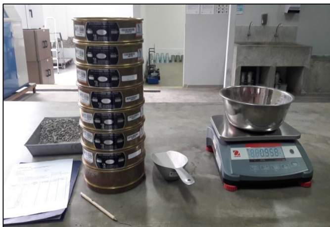
Foto N°12. Instrumentos para el Ensayo Granulométrico para la muestra de la arena gruesa reciclada-
