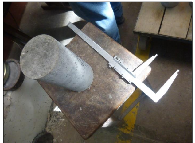
Foto N°30. Medición de las Probetas cilíndricas, con vernier.
