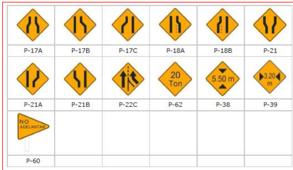
Figura 73: señales preventivas – restricciones físicas
