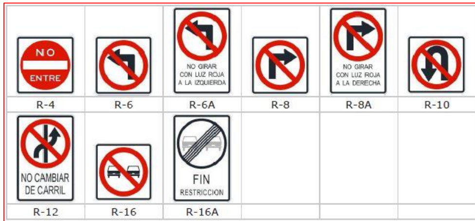
Figura 59: señales de prohibición de maniobras
