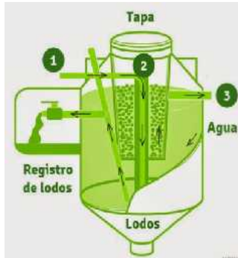
Figura 46: Funcionamiento del biodigestor
