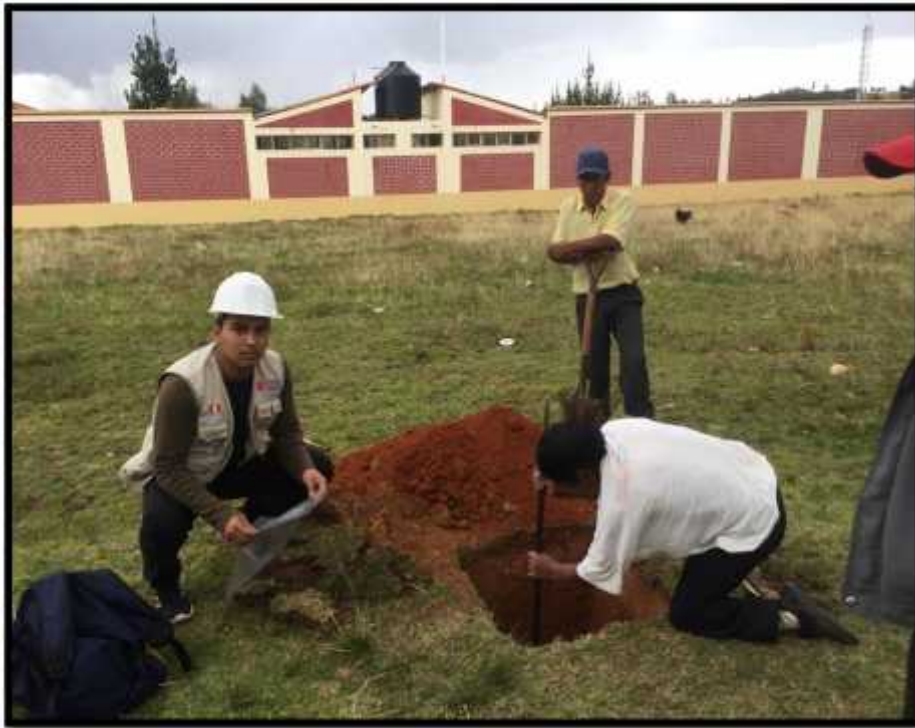
Figura 53: Extracción de las muestras de suelos.
