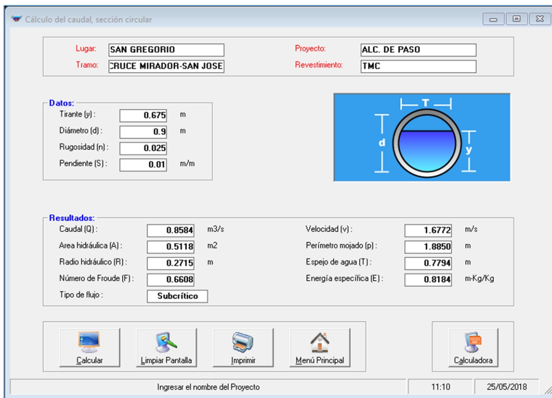
Figura 15: Cálculo hidráulico de alcantarillas de paso
