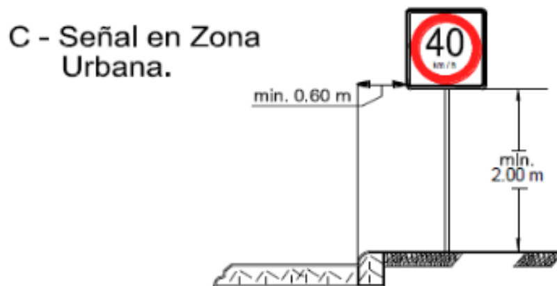
Figura 32: Colocación de señales en zona urbana
