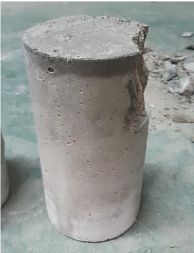
Anexo 1.31. Muestra N° 3 - Fractura de lados en las bases
