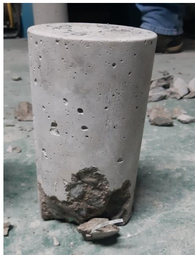
Anexo 1.7. Muestra N° 3 - Fractura de lados en las bases
