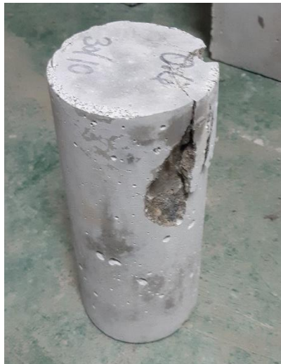
Anexo 1.47. Muestra N° 3 - Fractura de lados en las bases
