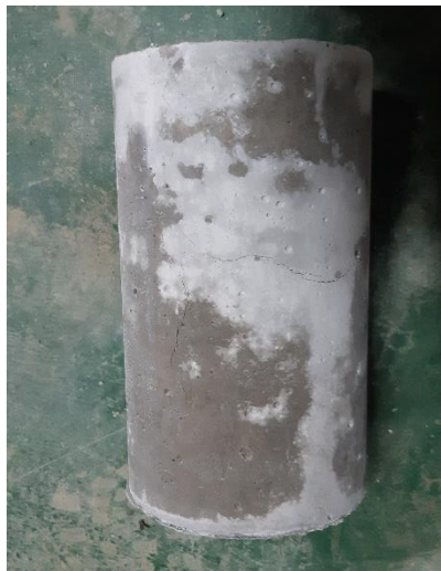
Anexo 1.91. Muestra N° 3 – Grieta vertical columnar en ambas bases, conos o bien formados.
