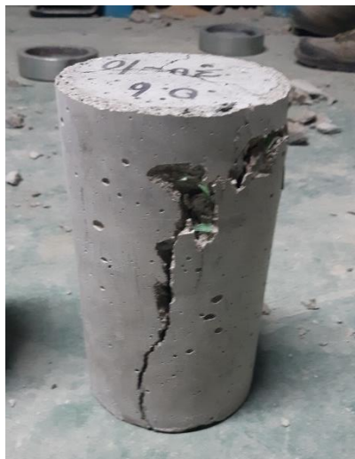
Anexo 1.15. Muestra N° 3 – fractura diagonal con grietas en las bases
