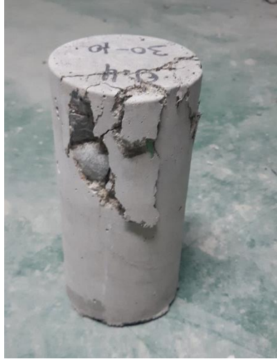
Anexo 1.5. Muestra N° 1 - Fractura de lados en las bases
