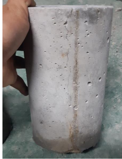
Anexo 1.54. Muestra N° 2 – Grieta vertical columnar en ambas bases, conos o bien formados.
