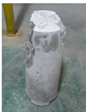
Figura 30. Muestra N° 1 - Fractura de lados en las bases.
