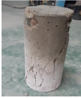
Figura 25. Muestra N° 1 - Fractura en diagonal con grietas en las bases
