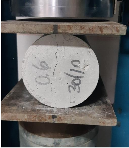
Anexo 1.77. Muestra N° 1 - Grieta vertical columnar en ambas bases, conos o bien formados.
