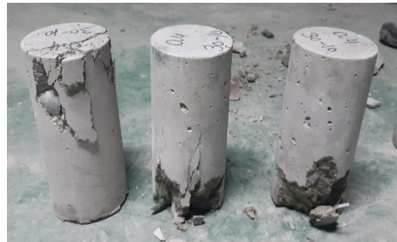
Anexo 1.8. Visualización de los 3 especímenes del Concreto + 0.4% Fibra Plástica
