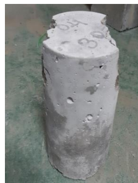
Figura 31. Muestra N° 2 - Fractura de lados en las bases
