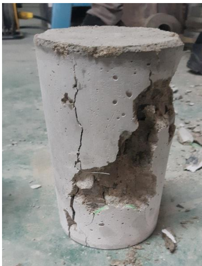
Anexo 1.27. Muestra N° 3 - Fractura en diagonal con grietas en las bases
