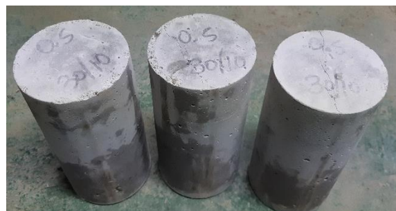
Anexo 1.92. Visualización de las 3 muestras del Concreto + 0.5% Fibra Plástica
