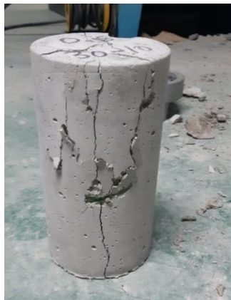
Figura 22 Muestra N° 3 - Grietas verticales columnares en ambas bases
