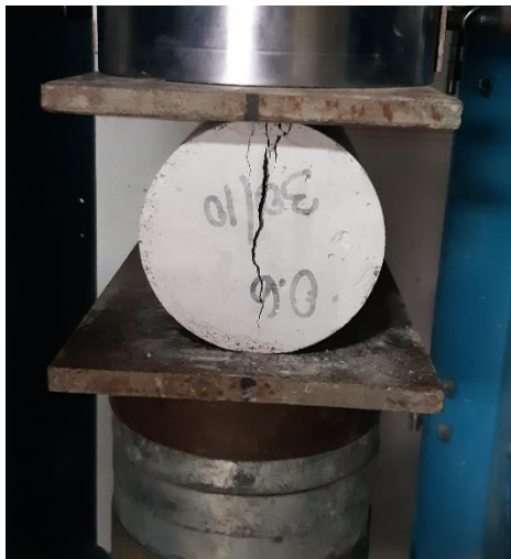
Anexo 1.79. Muestra N° 3 – Grieta vertical columnar en ambas bases, conos o bien formados.
