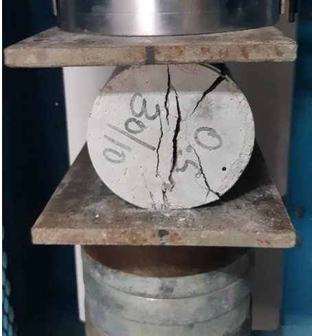
Anexo 1.73. Muestra N° 1 - Grieta vertical columnar en ambas bases, conos o bien formados.
