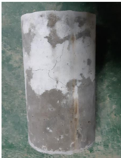
Anexo 1.83. Muestra N° 3 – Grieta vertical columnar en ambas bases, conos o bien formados.
