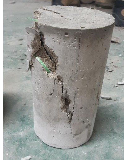
Anexo 1.26. Muestra N° 2 - Fractura en diagonal sin grietas en las bases
