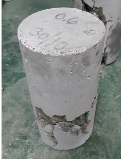
Anexo 1.45. Muestra N° 1 - Fractura de lados en las bases
