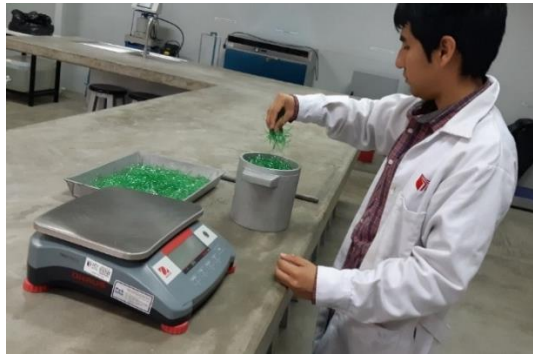
Figura 10. Ensayo Peso Unitario Suelto – Fibra Plástica PET
