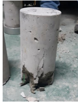
Figura 21. Muestra N° 2 - Fractura de lados en las bases
