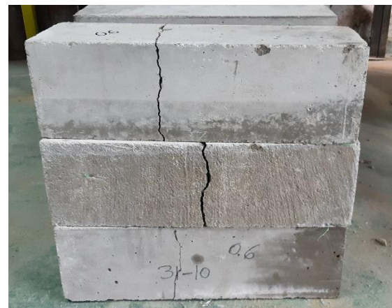
Anexo 1.112. Visualización de las 3 muestras del Concreto + 0.6% Fibra Plástica
