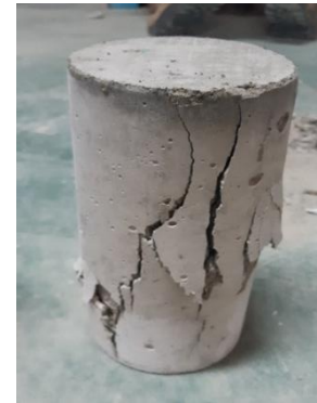
Figura 28. Muestra N° 4 - Grietas verticales columnares en ambas bases, conos bien formados.
