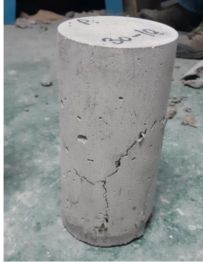
Anexo 1.2. Muestra N° 2 - Fractura en diagonal con grietas
