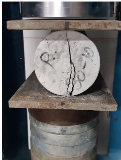
Anexo 1.66. Muestra N° 2 - Grieta vertical columnar en ambas bases, conos o bien formados.
