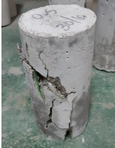
Anexo 1.41. Muestra N° 1 - Fractura diagonal con grietas en las bases
