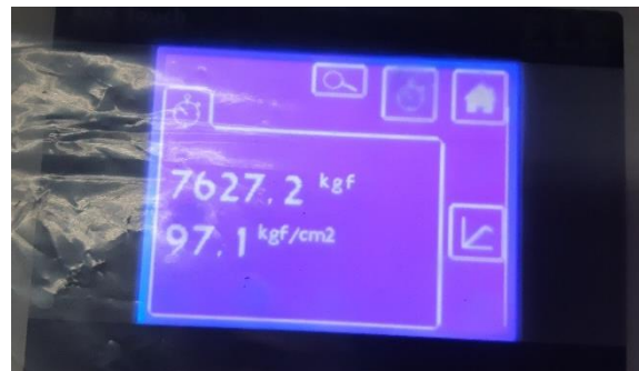
Anexo 1.76. Visualización de resultado obtenido por la maquina hidráulica de ensayo a tracción por compresión diametral.
