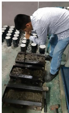
Figura 17. Fabricación de Vigas Prismáticas
