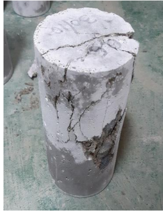
Figura 32. Muestra N° 3 – Cono bien formado sobre una base, desplazamiento de grietas verticales a través de las capas
