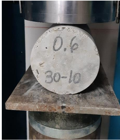
Anexo 1.93. Muestra N° 1 - Grieta vertical columnar en ambas bases, conos o bien formados.
