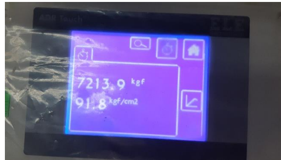
Anexo 1.68. Visualización de resultado obtenido por la maquina hidráulica de ensayo a tracción por compresión diametral.
