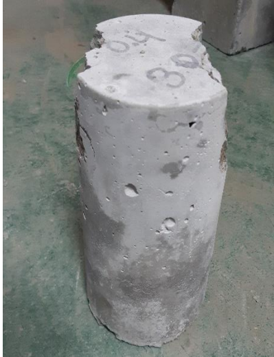
Anexo 1.37. Muestra N° 1 - Fractura de lados en las bases
