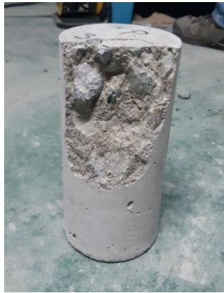
Figura 20. Muestra N° 1 - Fractura de lados en las bases
