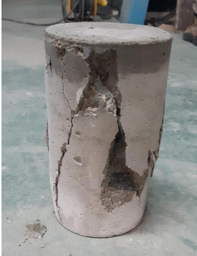
Anexo 1.29. Muestra N° 1 - Grietas verticales columnares en ambas bases, conos o bien formados
