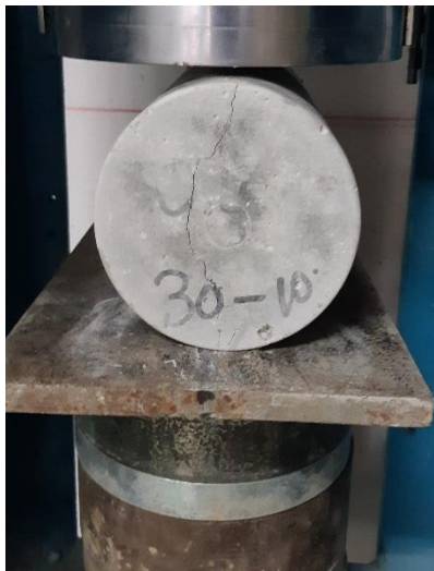
Anexo 1.87. Muestra N° 3 – Grieta vertical columnar en ambas bases, conos o bien formados.
