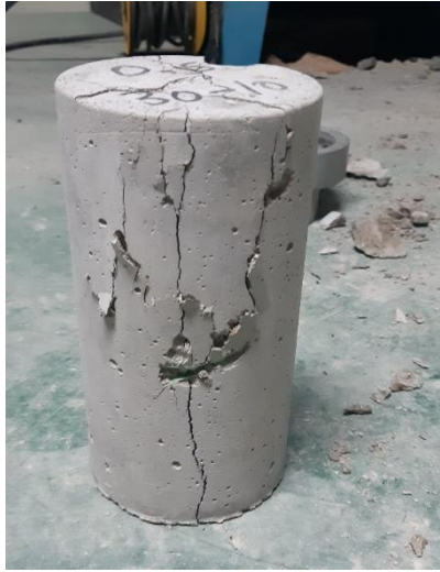
Anexo 1.9. Muestra N° 1 - Grietas verticales columnares en ambas bases
