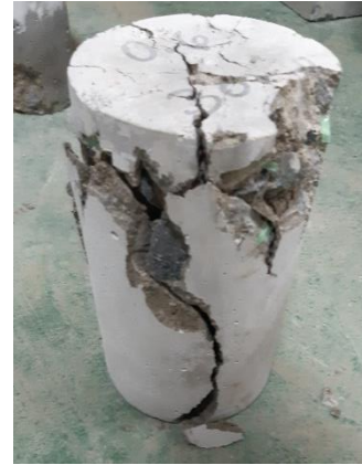
Figura 33. Muestra N° 4 – Fractura diagonal con grieta en las bases
