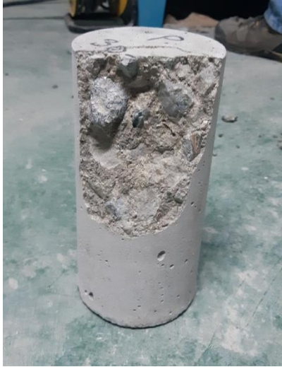
Anexo 1.1. Muestra N° 1 - Fractura de lados en las bases
