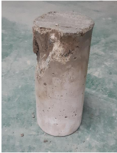
Anexo 1.17. Muestra N° 1 - Fractura de lados en las bases
