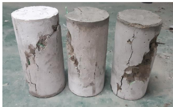
Anexo 1.28. Visualización de las 3 muestras del Concreto + 0.5% Fibra Plástica
