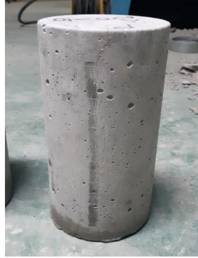
Anexo 1.50. Muestra N° 2 – Grieta vertical columnar en ambas bases, conos o bien formados.
