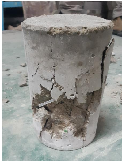
Anexo 1.22. Muestra N° 2 - Fractura en diagonal con grietas en las bases
