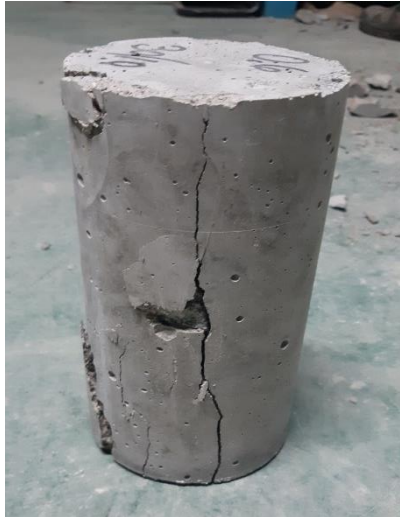
Anexo 1.13. Muestra N° 1 - Grietas verticales columnares en ambas bases
