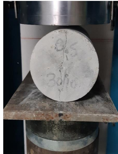
Anexo 1.90. Muestra N° 2 - Grieta vertical columnar en ambas bases, conos o bien formados.
