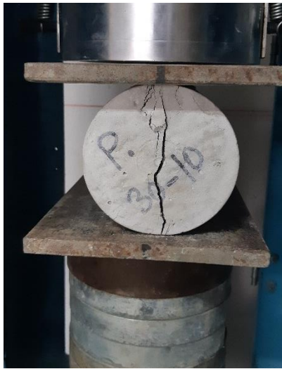
Anexo 1.65. Muestra N° 1 - Grieta vertical columnar en ambas bases, conos o bien formados.
