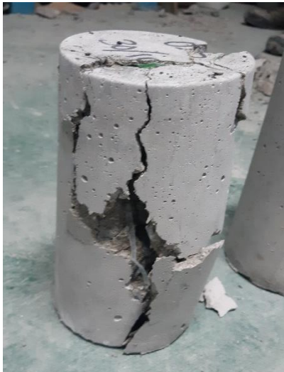
Anexo 1.11. Muestra N° 3 - Grietas verticales columnares en ambas bases
