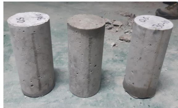
Anexo 1.60. Visualización de las 3 muestras del Concreto + 0.5% Fibra Plástica
