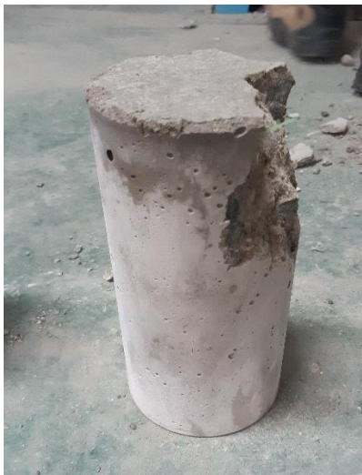
Anexo 1.23. Muestra N° 3 - Fractura de lados en las bases
