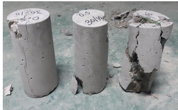
Anexo 1.12. Visualización de los 3 especímenes del Concreto + 0.5% Fibra Plástica
