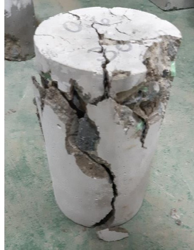
Anexo 1.46. Muestra N° 2 – Fractura diagonal con grieta en las bases
