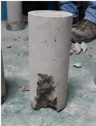
Anexo 1.3. Muestra N° 3 - Fractura de lados en las bases
