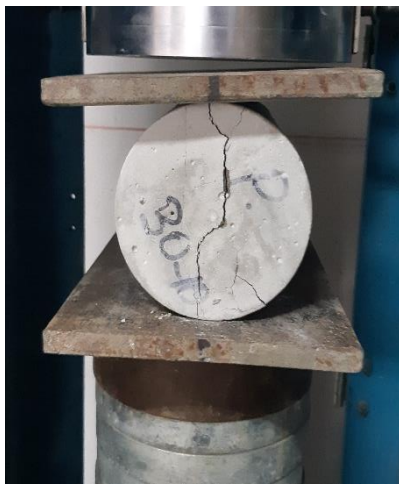
Anexo 1.67. Muestra N° 3 – Grieta vertical columnar en ambas bases, conos o bien formados.
