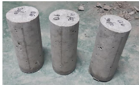
Anexo 1.64. Visualización de las 3 muestras del Concreto + 0.6% Fibra Plástica
