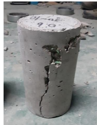
Figura 23. Muestra N° 4 - Fractura diagonales con grietas en las bases
