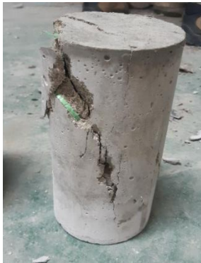
Figura 27. Muestra N° 3 - Fractura en diagonal sin grietas en las bases.
