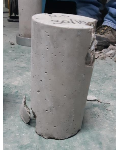
Anexo 1.10. Muestra N° 2 - Fractura de lados en las bases
