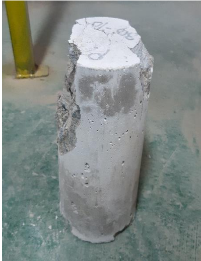
Anexo 1.33. Muestra N° 1 - Fractura de lados en las bases
