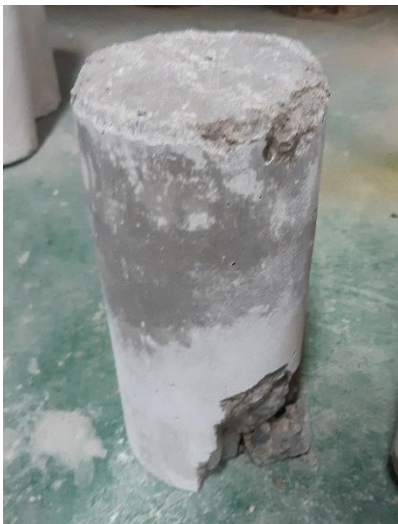
Anexo 1.35. Muestra N° 3 - Fractura de lados en las bases
