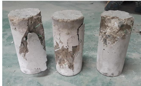
Anexo 1.24. Visualización de las 3 muestras del Concreto + 0.4% Fibra Plástica
