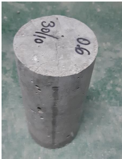
Anexo 1.63. Muestra N° 3 - Grieta vertical columnar en ambas bases, conos o bien formados.
