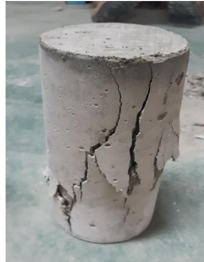
Anexo 1.30. Muestra N° 2 – Grietas verticales columnares en ambas bases, conos o bien formados
