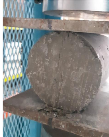
Anexo 1.78. Muestra N° 2 - Grieta vertical columnar en ambas bases, conos o bien formados.
