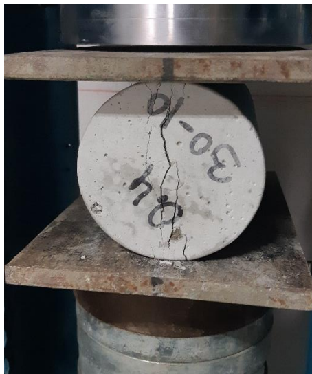
Anexo 1.71. Muestra N° 3 – Grieta vertical columnar en ambas bases, conos o bien formados.
