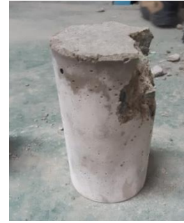
Figura 26. Muestra N° 2 - Fractura de lados en las bases
