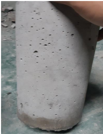
Anexo 1.51. Muestra N° 3 – Grieta vertical columnar en ambas bases, conos o bien formados.
