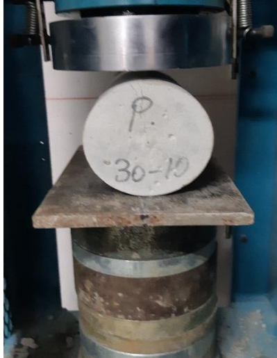
Anexo 1.81. Muestra N° 1 - Grieta vertical columnar en ambas bases, conos o bien formados.
