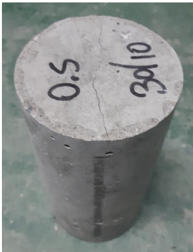
Anexo 1.59. Muestra N° 3 – Grieta vertical columnar en ambas bases, conos o bien formados.
