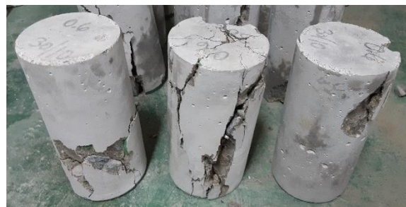
Anexo 1.48. Visualización de las 3 muestras del Concreto + 0.6% Fibra Plástica
