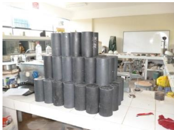
Figura 2. Moldes plásticos para probetas, dimensiones 4 x 8 pulg.
