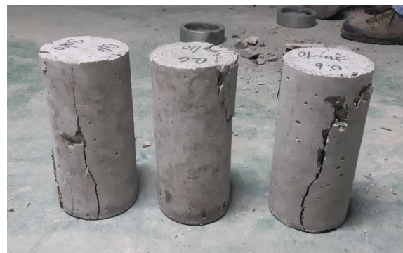
Anexo 1.16. Visualización de los 3 especímenes del Concreto + 0.6% Fibra Plástica
