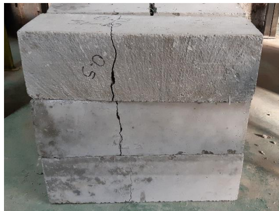
Anexo 1.108. Visualización de las 3 muestras del Concreto + 0.5% Fibra Plástica
