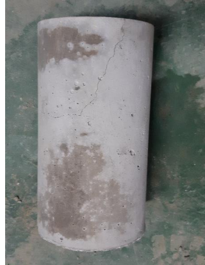
Anexo 1.94. Muestra N° 2 - Grieta vertical columnar en ambas bases, conos o bien formados.
