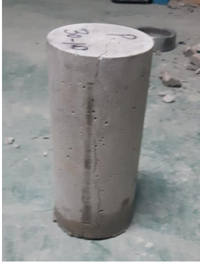
Anexo 1.49. Muestra N° 1 – Grieta vertical columnar en ambas bases, conos o bien formados.
