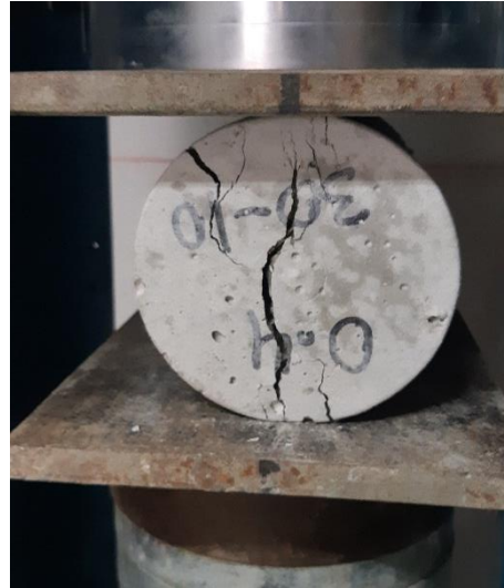
Anexo 1.70. Muestra N° 2 - Grieta vertical columnar en ambas bases, conos o bien formados.
