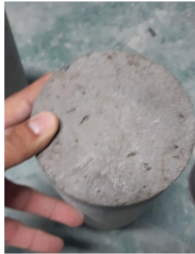
Anexo 1.58. Muestra N° 2 - Grieta vertical columnar en ambas bases, conos o bien formados.
