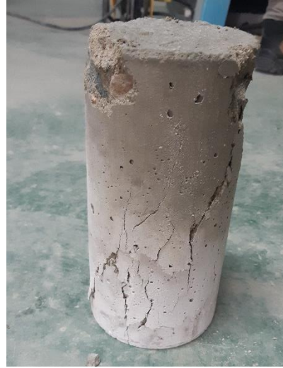
Anexo 1.18. Muestra N° 2 - Fractura en diagonal con grietas en las bases
