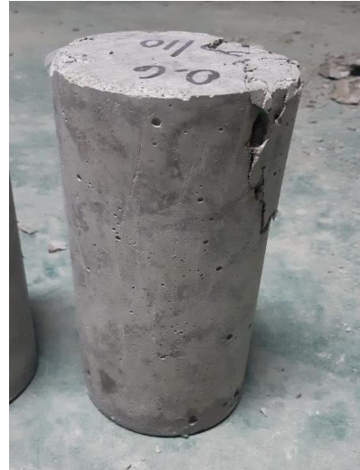
Anexo 1.14. Muestra N° 2 - Fractura de lados en las bases
