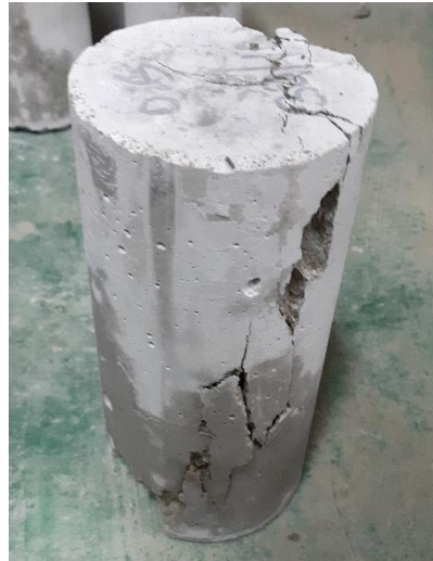
Anexo 1.42. Muestra N° 2 - Fractura diagonal con grietas en las bases
