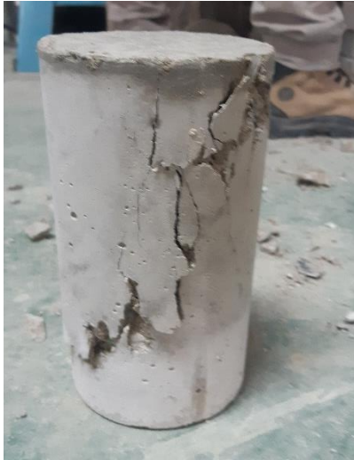
Anexo 1.25. Muestra N° 1 - Fractura en diagonal sin grietas en las bases
