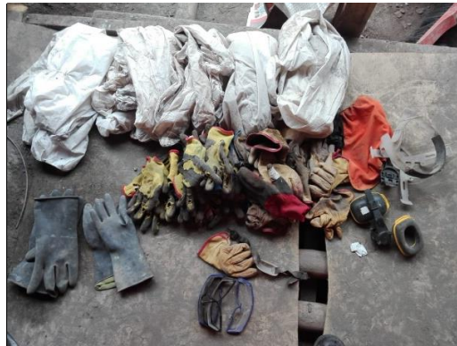
Figura 3-9. EPI en pésimas condiciones.
