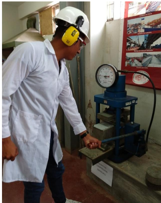
Figura 27. Viga en la máquina de ensayo
