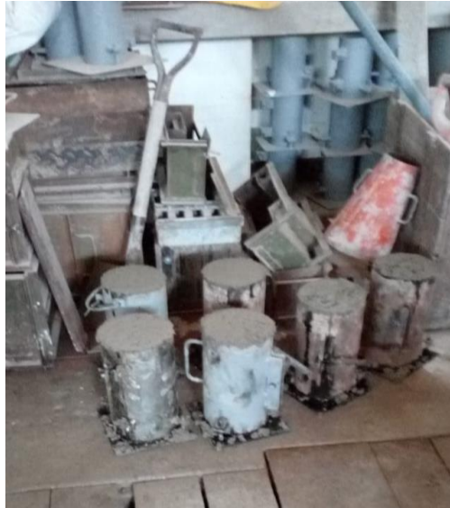
Figura 15. Elaboración de probetas con concreto patrón
