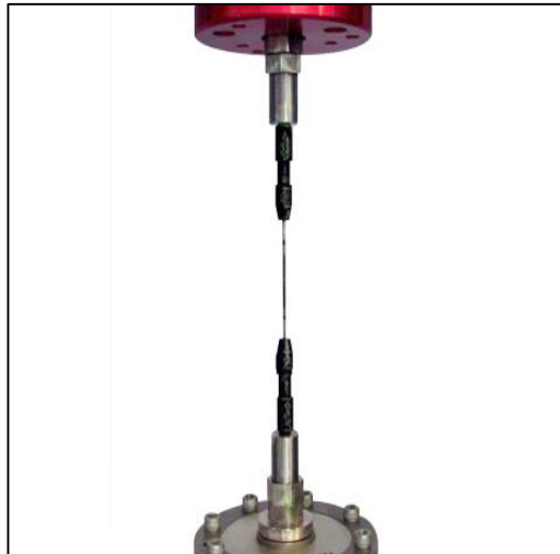
Figura 2. Ensayo de fatiga y fractura de alambres de refuerzo de neumáticos
