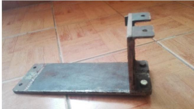
*Figura 3.8.* Angulo de 1.1/2" ala x 1.1/2" ala x1.1/2" longitud x 3/16" espesor.
