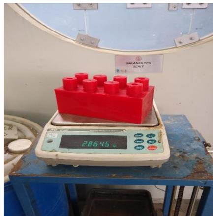
Figura 3.21. Pesaje de ladrillo de plástico reciclado M2.
