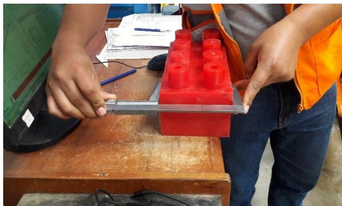
*Figura 3.24. Medición de ancho ladrillo de plástico reciclado.*
