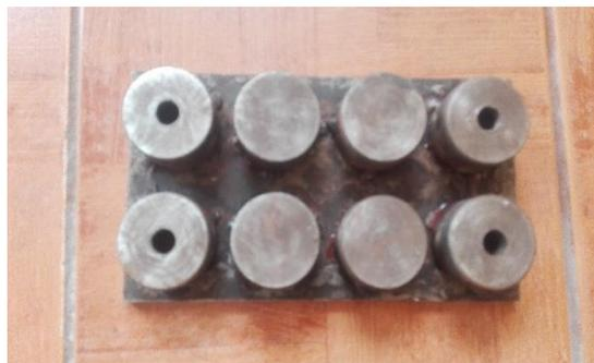
*Figura 3.10.*El molde de 8 cilindros rectos de (35mm de altura x 50mm de diámetro)
