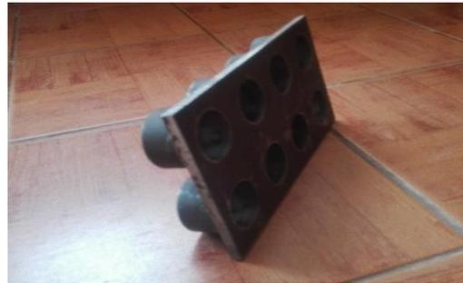
*Figura 3. 9.*plancha superior (plancha de 240mm x 130mm x 8mm espesor)
