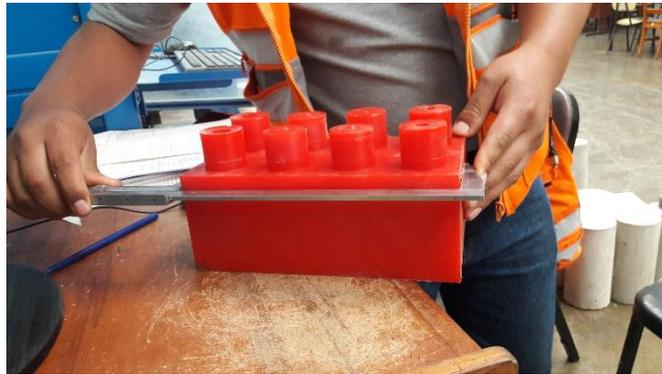
*Figura 3.23. Medición de longitud del ladrillo de plástico reciclado*
