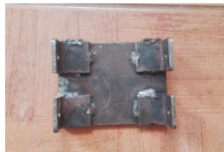
*Figura 3.7.*Plancha de 330mm largo x 110mm ancho x 8mm de espesor
