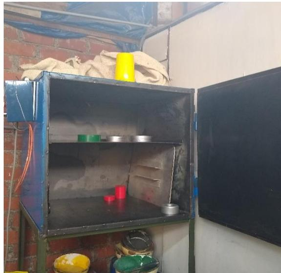
Figura 3.17. Horno eléctrico 140 °c en 24 hr (secado).
