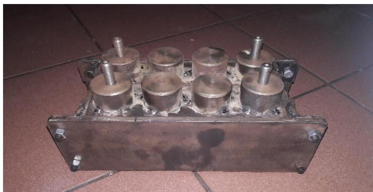
*Figura 3.13.*Moldeo del ladrillo, 10 .45 código de la plancha, perfil del molde .
