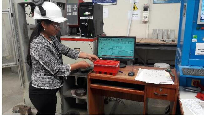
*Figura 3.22. Medición de longitud ladrillo de plástico reciclado.*
