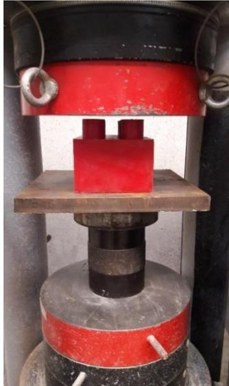
Figura 3.27. Resistencia a compresión del ladrillo de plástico reciclado M1-M2,  $C(\text{kgf}/\text{cm}^2) = W/A$
