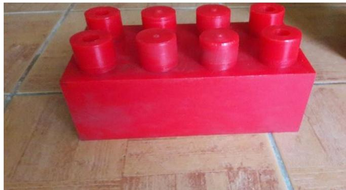
*Figura 3.19.* Molde de ladrillo de plástico reciclado tipo lego.
