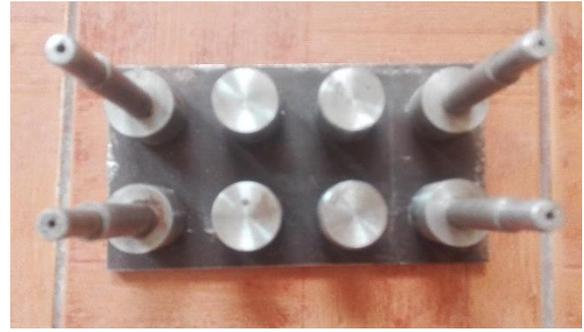
*Figura 3.11.* Plancha inferior (plancha de 240mm x 130mm x 8mm espesor),8 perforaciones de 38mm de diámetro interior,8 cilindros rectos de (45mm altura x 38mm de diámetro) pin de 17mm de diámetro rebajado, 11mm de diámetro a 2 cilindros rectos de cada extremo.
