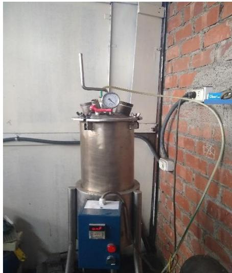
*Figura 3.15.* Proceso de inyección 150°C.
